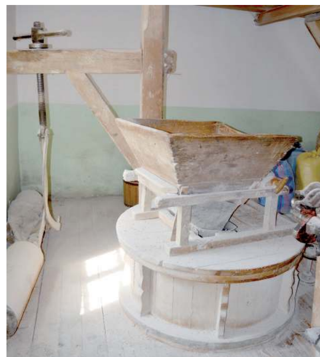
Tak wygląda śrutownik, który ze zboża produkuje śrutę, czyli pokarm dla zwierząt gospodarskich. – To chyba pierwsze urządzenie od króla Sobieskiego, które cały czas istnieje. Jeszcze cały czas działa, tylko kamienie były wymieniane – mówi właściciel młyna.
