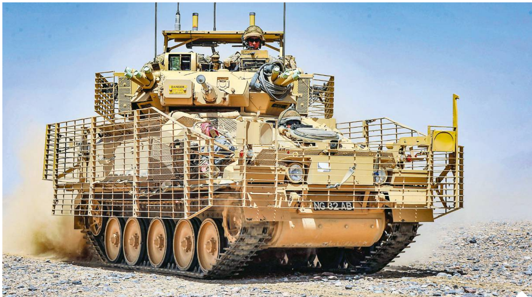
CVR(T) wyposażony w silnik benzynowy Jaguar J60 o mocy 190 KM może osiągnąć prędkość ok. 80 km/h. Jego zasięg wynosi 483 km | fot. Wikipedia/d
