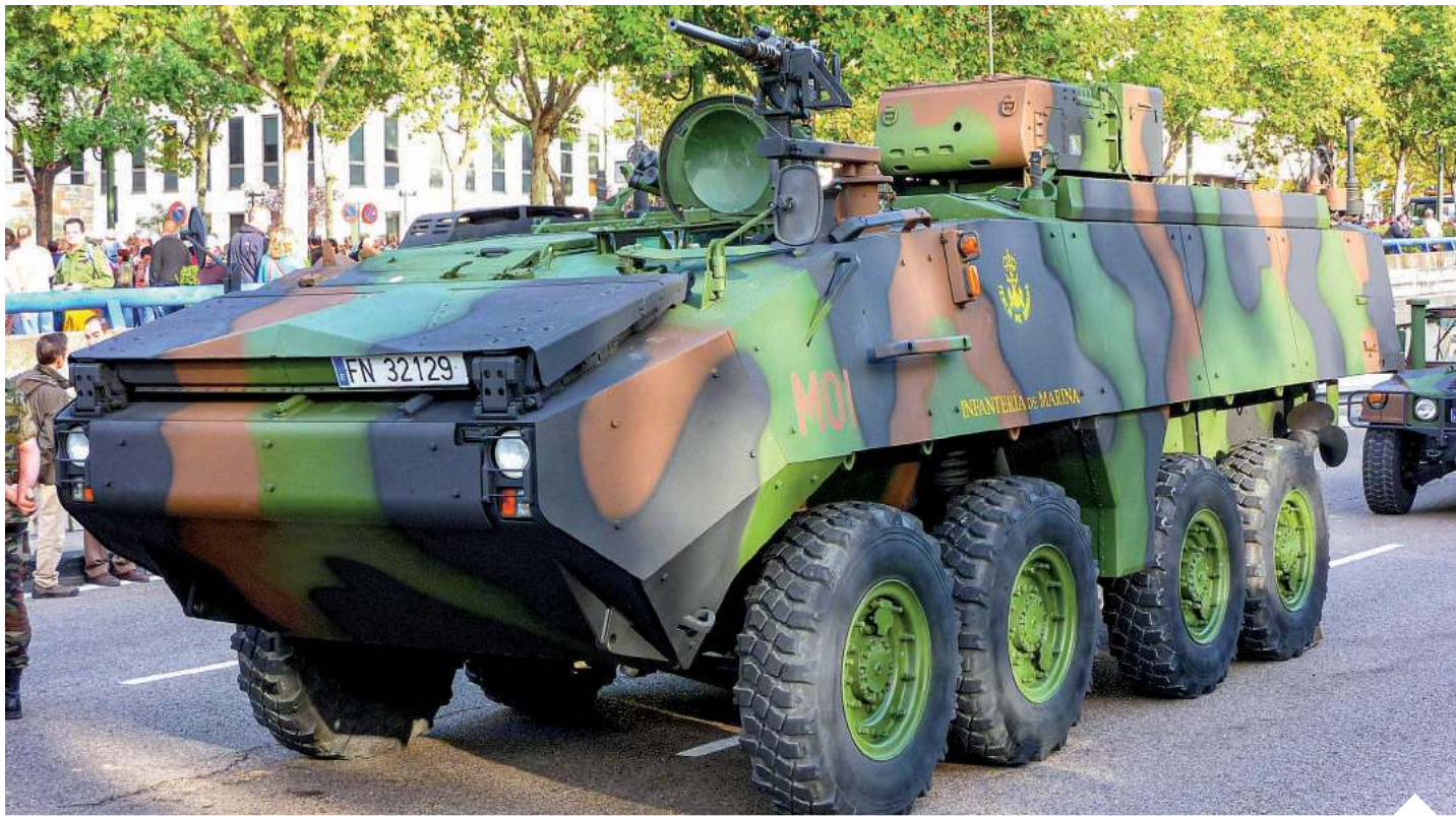
Mowag Piranha V to 30-tonowy pojazd, którego załogę stanowi trzech żołnierzy, ponadto jest w stanie zabrać ze sobą ośmiu wojskowych desantu | fot. Wikipedia/d
