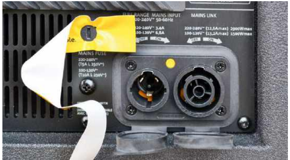
U dołu panelu – tak S118R, jak i X15 – umieszczono gniazdo wejściowe oraz wyjściowe zasilania z sieci napięcia przemiennego typu POWERCON TRUE1.
