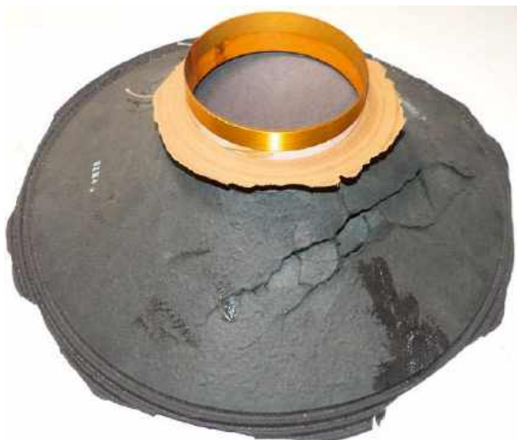
Wiele głośników ulega uszkodzeniom z powodu kiepskiej jakości membran.
