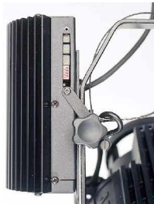
Cyfrowy (sterowany DMX-em) dimmer indywidualny, montowany bezpośrednio do yoke'u lampy.
