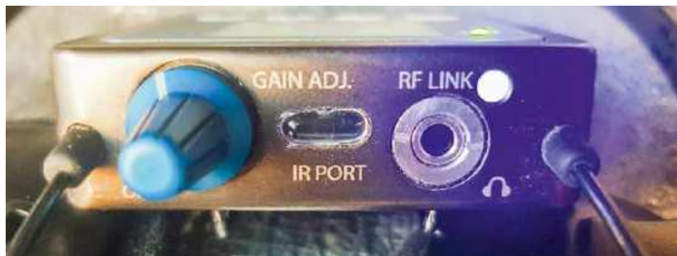
U góry odbiornika znajdziemy dwie elastyczne anteny prętowe, zainstalowane na stałe, gniazdo do podłączenia słuchawek (jack 1/8"), niebieskie pokrętko głośności sygnału w słuchawkach, port IR oraz niebieską diodę RF LINK.
