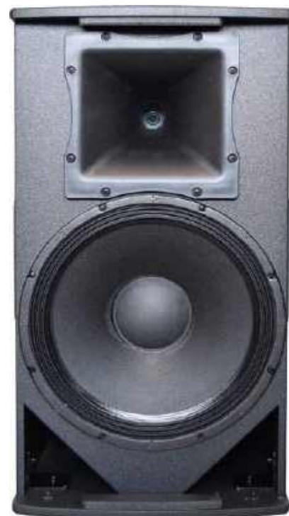
W dolnej części przedniej ścianki wykonano dwa duże trójkątne otwory bass-reflex.
