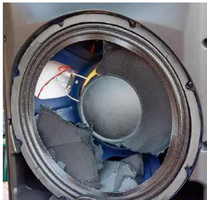
Całkowita destrukcja membrany bez udziału użytkownika.
