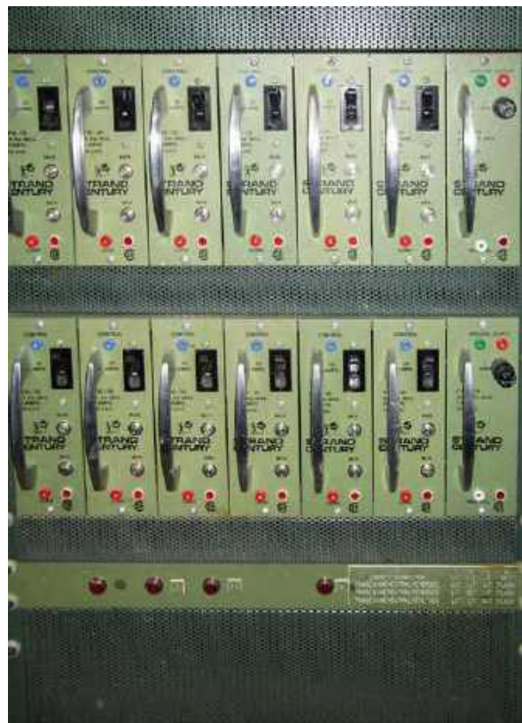
Konstrukcje z lat późniejszych również nie grzeszyły kompaktowością wymiarów – dimmery na zdjęciu (z lat 70. ubiegłego wieku) określane były jako „pół-przenośne” (semi-portable).
