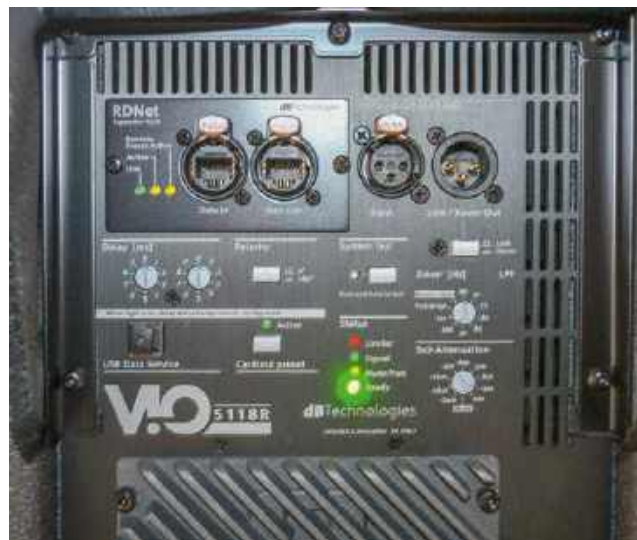
Architektura panelu przyłączeniowo-kontrolnego zestawu basowego jest podobna do panelu zestawu VIO X15, jednak pamiętać należy, że dotyczy subbasu, czyli ma nieco inne funkcje.
