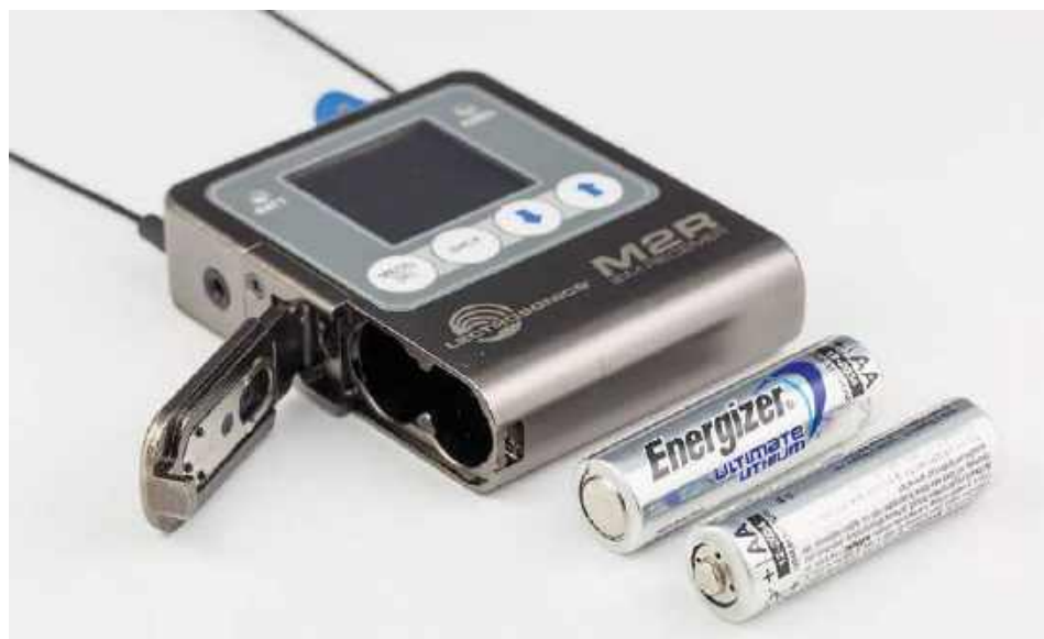
Odbiornik zasilany jest z dwóch baterii lub akumulatorów typu AA (R6).
