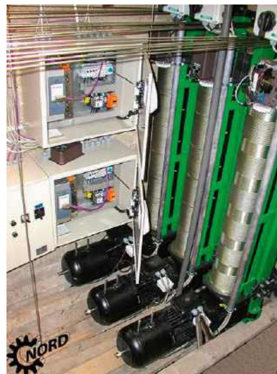
Napędy elektromechaniczne mają istotne zalety w stosunku do bardziej złożonych i wymagających intensywniejszej konserwacji napędów hydraulicznych.
