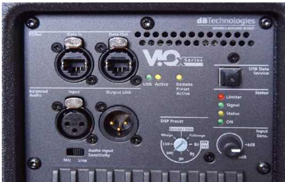
VIO X15 wyposażono w gotowe preset, które wybiera się za pośrednictwem obrotowego przełącznika.
