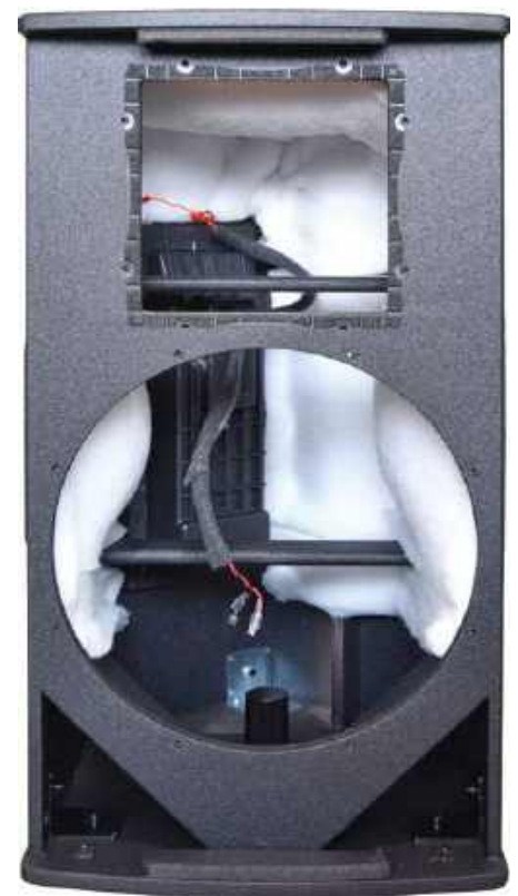
Wnętrze zestawu jest częściowo wytłumione.
