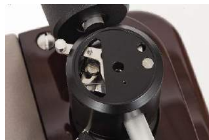
Po zdjęciu górnej osłony ramienia uzyskujemy dostęp do regulacji azymutu.
