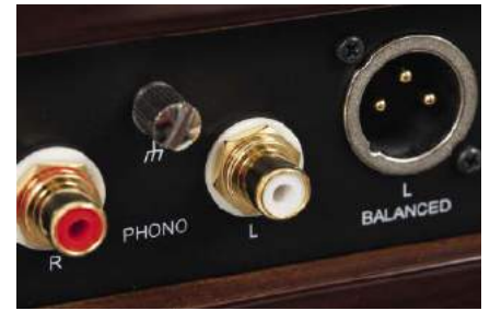
Wyjścia XLR pozwalają wyciągnąć z wkładki MC sygnał zbalansowany.
