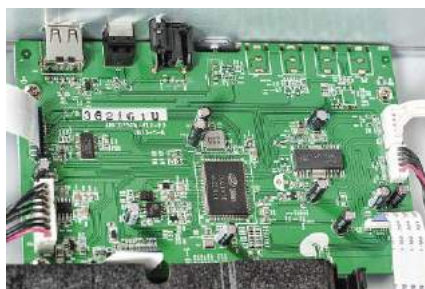
Umieszczona za mechanizmem płytka to sekcja z odczytaczem plików wysokiej rozdzielczości (z płyty i USB).
