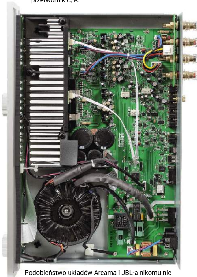
Układ elektroniczny CD350 podzielono na trzy główne moduły – zasilacz, odtwarzacz (płyt i plików) oraz przetwornik C/A.
