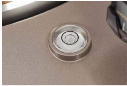
W tym celu zainstalowano na niej poziomice.
