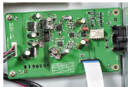
DAC to kompletna płytka z przetwornikiem (Burr Brown PCM 1796) i sekcją analogową (scalone wzmacniacze operacyjne).
