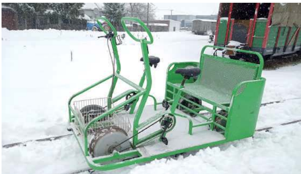
Drezyna rowerowa to lekki czterokołowy pojazd napędzany siłą mięśni ludzkich. Zmieści się w niej cztery, maksymalnie pięć osób
