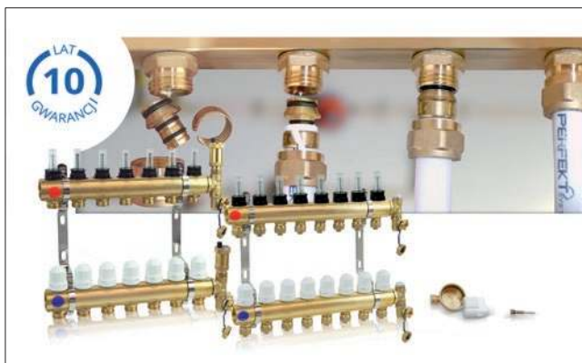
Rozdzielacze mosiężne z rotametrami (belka zasilająca) oraz zaworami i korkami (belka powrotna) z widocznymi podłączeniami przewodów instalacyjnych
