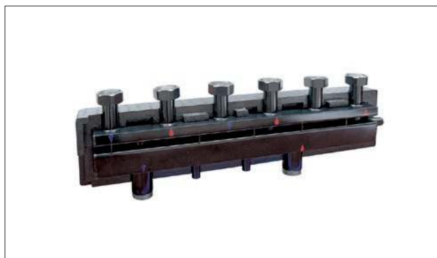
Sprzęgło-rozdzielacz do instalacji c.o., odpowiedzialny za zrównoważenie hydrauliczne obiegów źródłowych i grzewczych oraz efektywne, indywidualnie regulowane rozprowadzanie ciepła do pomieszczeń
