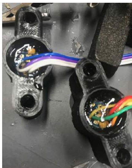
Fotografia 4. Sensor zalany żywicą w obudowie
