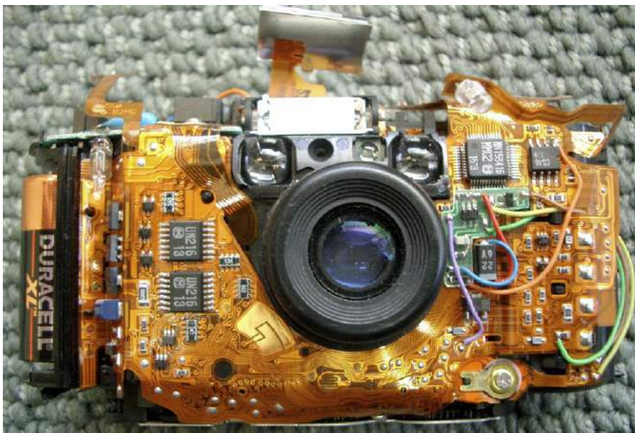
Fotografia 2. Przykładowe urządzenie elektroniczne (aparat cyfrowy) zawierające dużą ilość laminatu elastycznego typu flex
