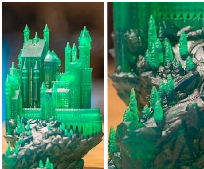
Fotografia 26. Wydruki w technologii SLA
