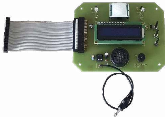
Fotografia 2. Wygląd zmontowanej płytki drukowanej z wyprowadzonymi przewodami do podłączenia komputera Raspberry Pi Zero W oraz karty dźwiękowej
