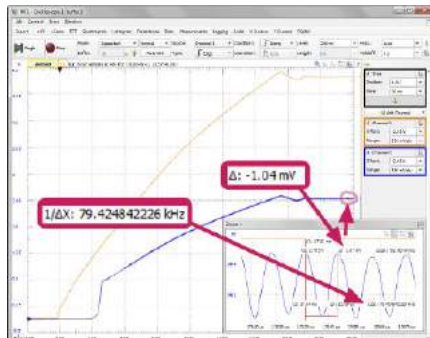
Rysunek 5. Pomiar oscylacji rzeczywistego bufora
