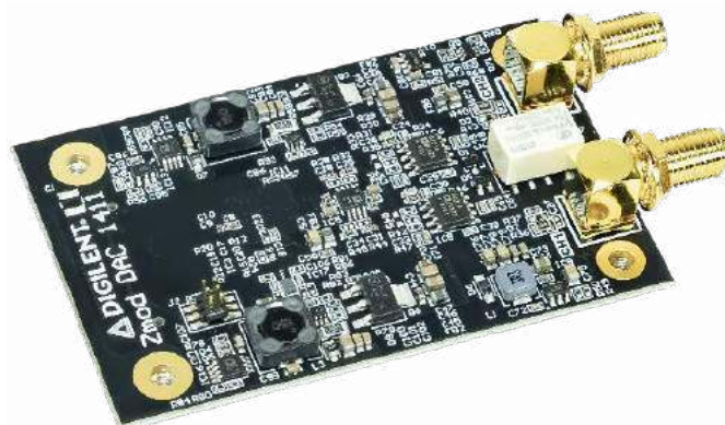
Fotografia 2. Wygląd karty rozszerzającej przetwornika DAC ZMOD DAC1411
