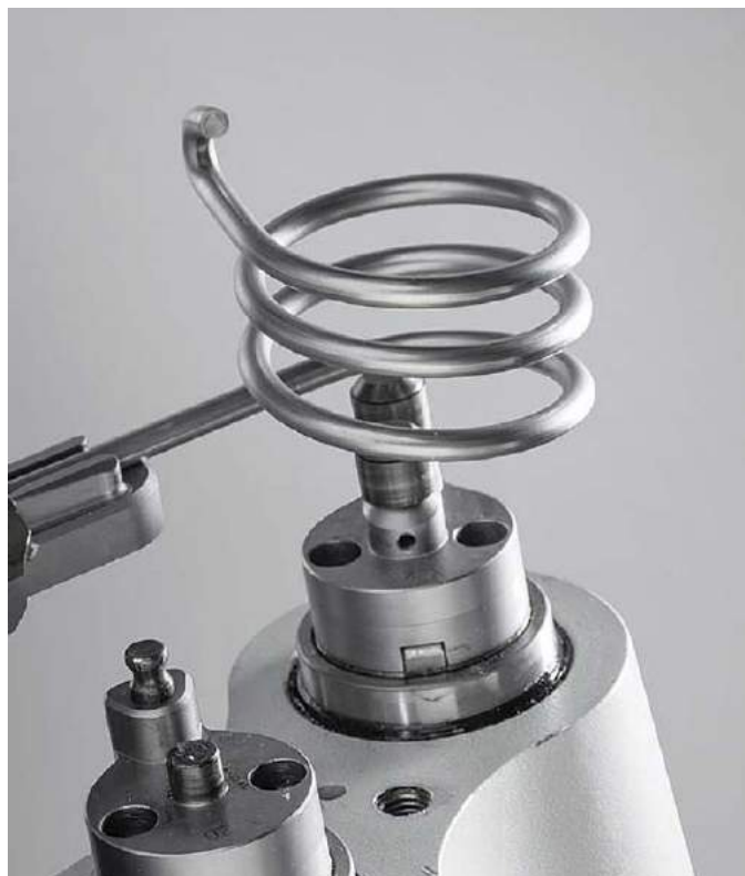
Fotografia 4. Element wykonany przy użyciu giętarki do drutu
