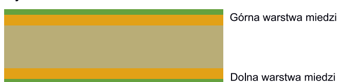
Rysunek 1. Budowa typowej płytki drukowanej jedno- (u góry) i dwuwarstwowej (na dole)
