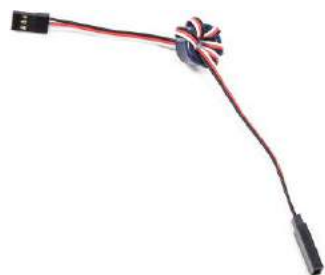
Fotografia 13. Dławik przeznaczony do filtracji zakłóceń
