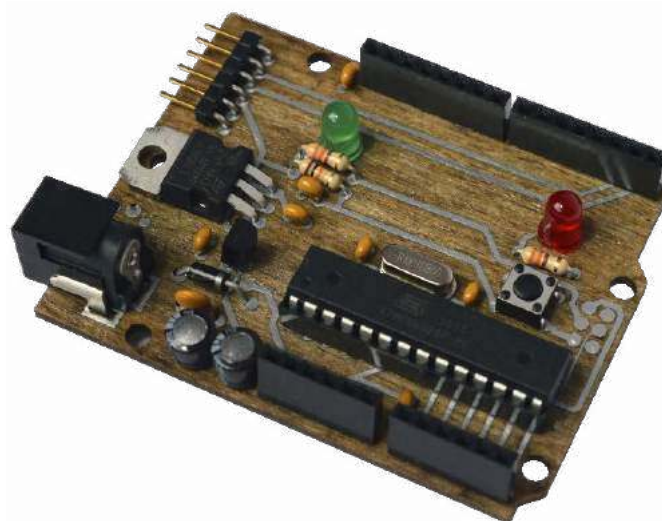
Fotografia 1. Działający moduł elektroniczny zbudowany na bazie płytki Soluboard (źródło: https://bit.ly/3ibj6iA )
