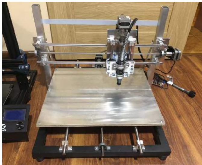
Fotografia 16. Frezarka wykonana samodzielnie
