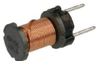
Fotografia 9. Dławik na pionowym rdzeniu do montażu przewlekane go
