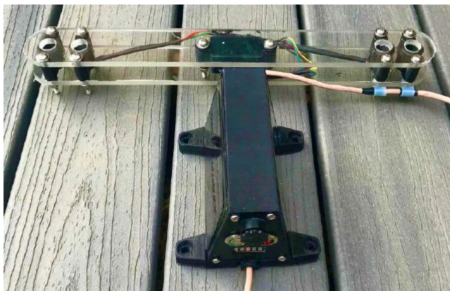
Fotografia 1. Gotowy moduł do pomiaru wysokości wody w oceanie
