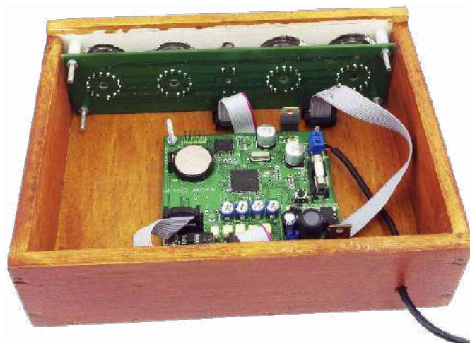
Fotografia 2. Zmontowane komponenty układu, widok na płytce wyświetlacza
