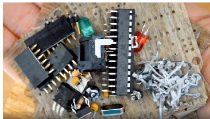
Fotografia 2. Po zanurzeniu modułu w gorącej wodzie elementy elektroniczne można łatwo usunąć z płytki (źródło: https://bit.ly/3ibj6iA )
