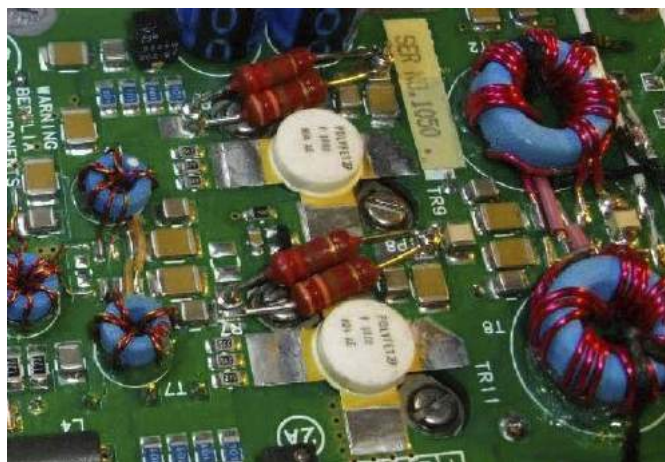
Fotografia 24. Przykładowe zastosowanie transformatorów wysokiej częstotliwości
