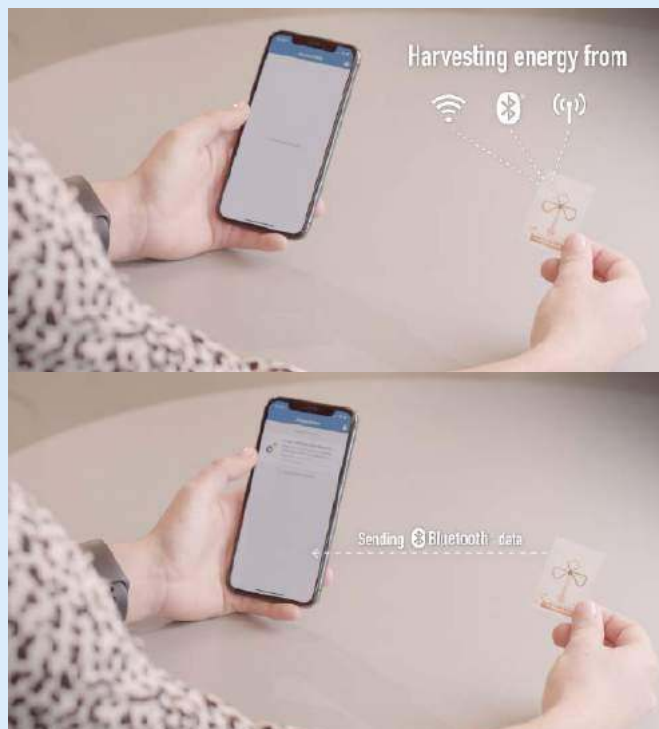
Fotografia 3. Przykład bezbaterijnej pracy z układem Wiliot [7]
