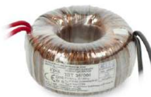
Fotografia 19. Transformator sieciowy z rdzeniem toroidalnym
