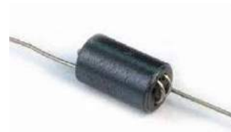
Fotografia 10. Dławik przystosowany do pracy przy wysokich częstotliwościach i ze stosunkowo znacznymi prądami
