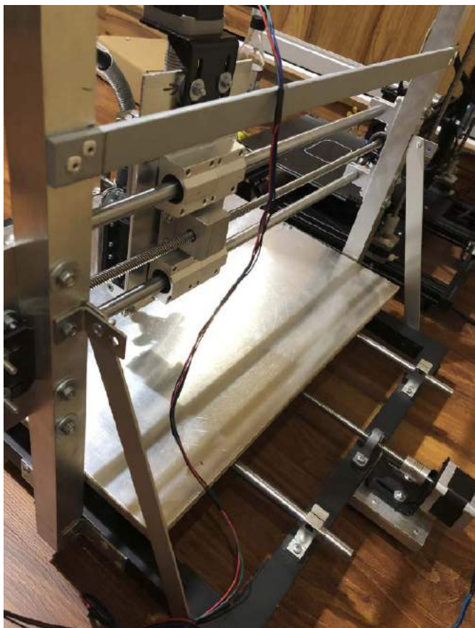
Fotografia 19. Połączenie tzw. bramy z podstawą
