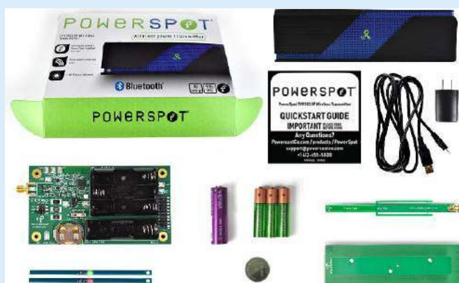
Fotografia 2. Zestaw uruchomieniowy PowerSpot firmy Powercast [6]
