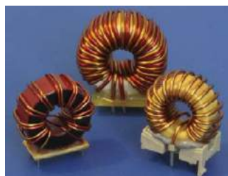
Fotografia 23. Transformatory wysokiej częstotliwości
