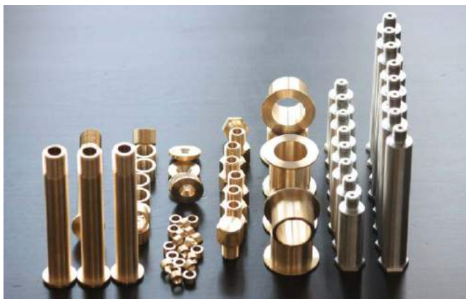
Fotografia 8. Przykładowe elementy metalowe wykonane przy użyciu tokarki
