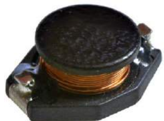
Fotografia 7. Dławik SMD z otwartym obwodem magnetycznym
