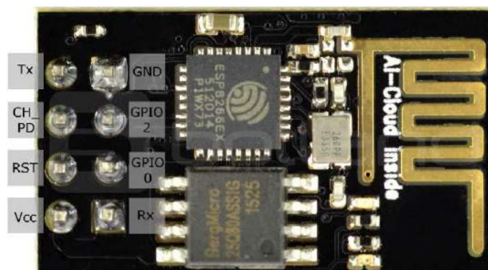
Rysunek 2. Moduł ESP826601 z podpisami wyprowadzeniami
