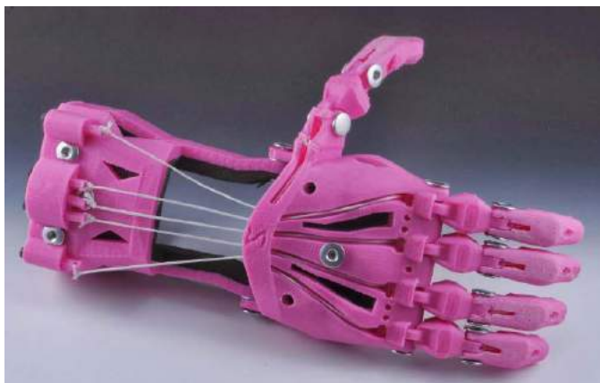
Fotografia 20. Proteza wydrukowana w technologii FDM
