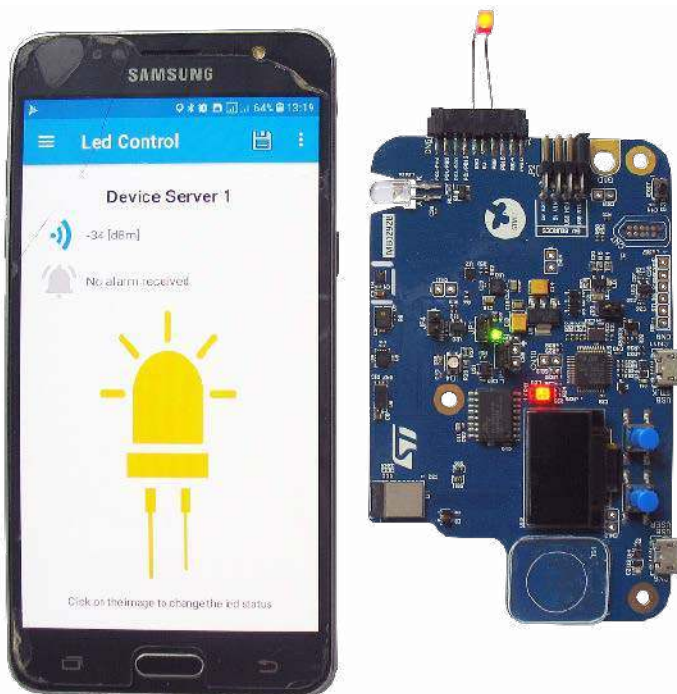
Fotografia 1. Widok działającego systemu BLE (od lewej: zdjęcie aplikacji ST BLE sensor po wysłaniu komunikatu o zapaleniu diody LED, zdjęcie płytki STM32WB5MM-DK z zapaloną diodą LED po otrzymaniu komunikatu)
