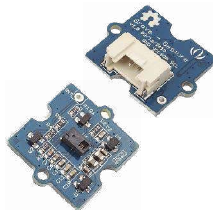
Fotografia 5. Moduł z układem scalonego sensora gestów PAJ7620U2
