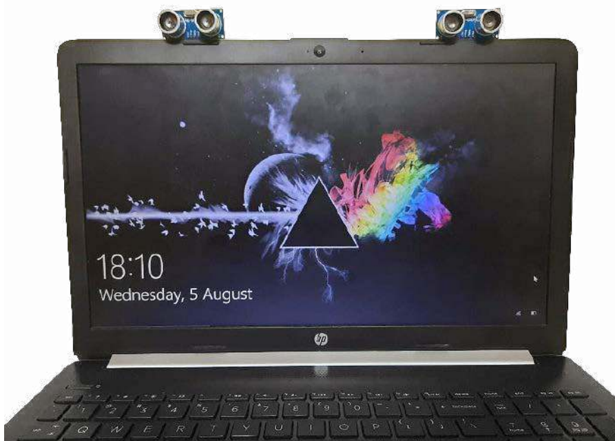
Fotografia 1. System rozpoznawania dźwięków za pomocą sensorów ultradźwiękowych, zamontowany w laptopie
