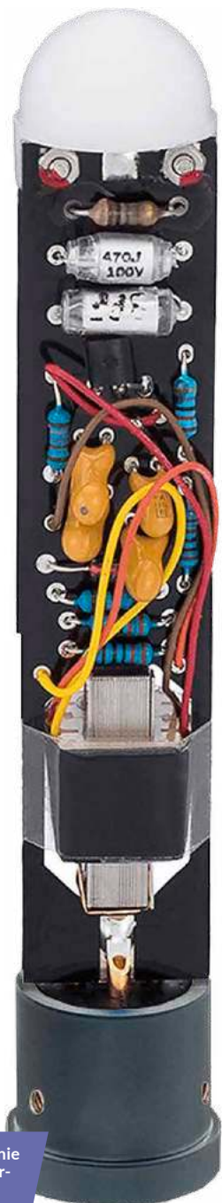
Backplate, czyli membrana stała kapsuły pojemnościowej w WA-84 (u góry) oraz Neumann KM 84. Choć konstrukcje nie są identyczne, a i materiał, z którego je wykonano jest inny, to jednak idea jest podobna.
