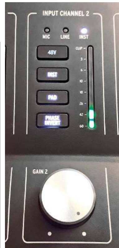
Tryb pracy wejść 1–4 przełącza się automatycznie z chwilą podłączenia źródła sygnału. Do tego momentu sygnał jest wyciszony w całym torze odsłuchu.
