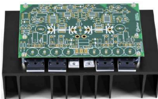
Rysunek 11. Zaznaczenie otworów dla tranzystorów mocy. Aby zwiększyć dokładność, tranzystory są umieszczone na podkładkach ceramicznych
