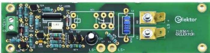
Rysunek 15. W pełni zmontowany układ ochronny. Pozostało jeszcze tylko przyłutować przełącznik i miedzianą cewkę domowej roboty
