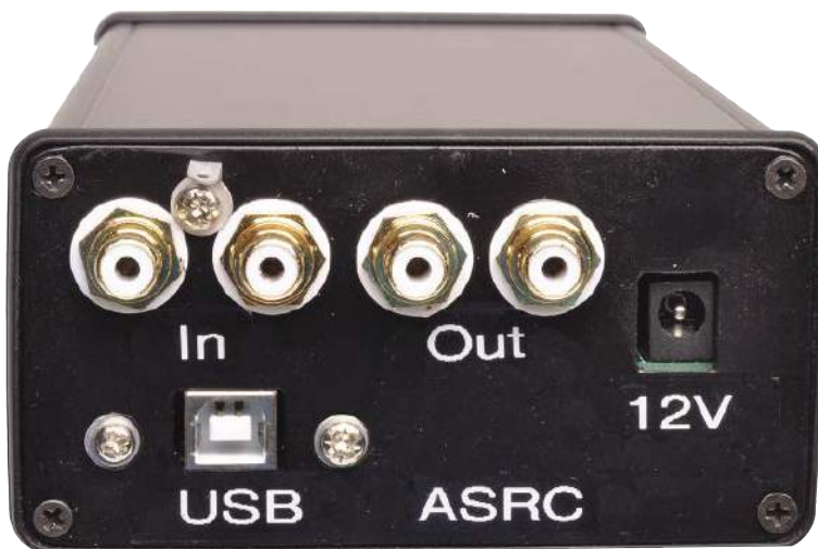
Z tyłu SuperCodec-a znajdują się wszystkie złącza wejściowe i wyjściowe (gniazda RCA) wraz ze złączem USB i gniazdem zasilania 12 V DC
