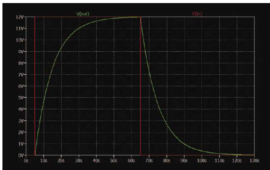
Rysunek 10. Wyniki symulacji z wykorzystaniem źródła impulsowego
