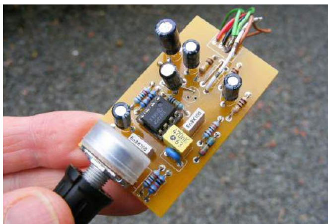
Rysunek 20. Foto zmienionej wersji układu na „starej” PCB; w związku z obecnością dodatkowego sygnału wejścia do regulatora barwy, zabrakło wyrowadzeń na przygotowanym złączu MOLEX; należy zwrócić uwagę na przewód biały (z czarnymi kreskami) oraz punkt lutowniczy, który wykorzystano na jego podłączenie (to sygnał INPUT); na podłączenie kondensatora C2 wykorzystano punkty lutownicze nieobecnego stabilizatora bocznikowego
