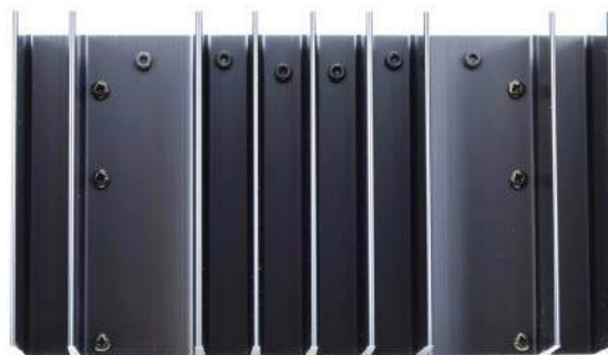
Rysunek 7. Tylna strona dużego radiatora. 12 czarnych łbów śrub jest ledwo zauważalnych
