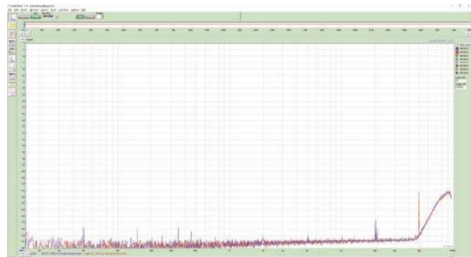
Rysunek 5. Poziom bazowy szumów ADC, mierzony przy zwartych wejściach. Największy pik w słyszalnym zakresie występuje przy 50 Hz, co jest skutkiem przenikania szumu sieciowego, ale nie stanowi to problemu, bo ma poziom poniżej -140 dB
