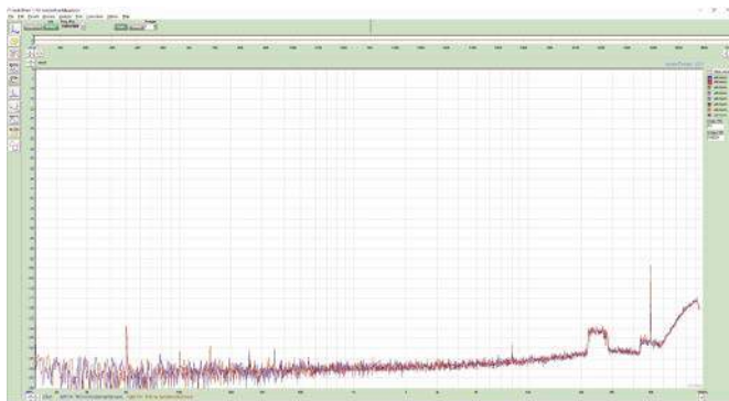
Rysunek 6. Poziom bazowy szumów kompletnego układu DAC+ADC. Jest on wyższy niż w przypadku samego ADC (na rysunku 5), ale nadal bardzo niski i wynosi około -130 dB
