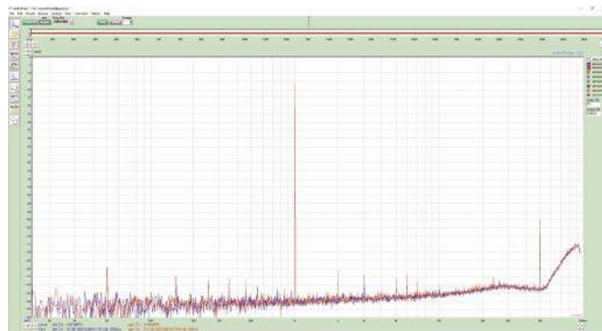
Rysunek 7. Tutaj amplituda sygnału testowego 1 kHz została zredukowana o 20 dB; zmniejszona z około 1 V RMS do około 0,1 V ( 100 mV) RMS. Leży to poniżej poziomu większości normalnych sygnałów „linia”, ale pomimo tego, poziom zniekształceń jest nadal znakomity, z THD mierzonym jako -112 dB/ 0,0002\% .
