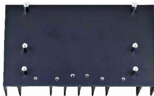
Rysunek 13. Gotowe otwory do montażu tranzystorów mocy
