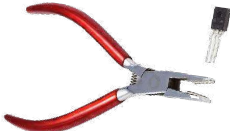
Rysunek 17. Aby uniknąć naprężeń wynikających z rozszerzalności cieplnej, końcówki tranzystorów sterownika są lekko wygięte. Można to zrobić bardzo łatwo za pomocą specjalnych szczypiec pokazanych tutaj, ale można to również zrobić za pomocą szczypiec okrągłych
