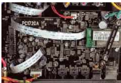
Najważniejszą modyfikacją jest przebudowana sekcja cyfrowa – to nie tylko nowe możliwości sieciowe, ale również lepszy przetwornik C/A.
