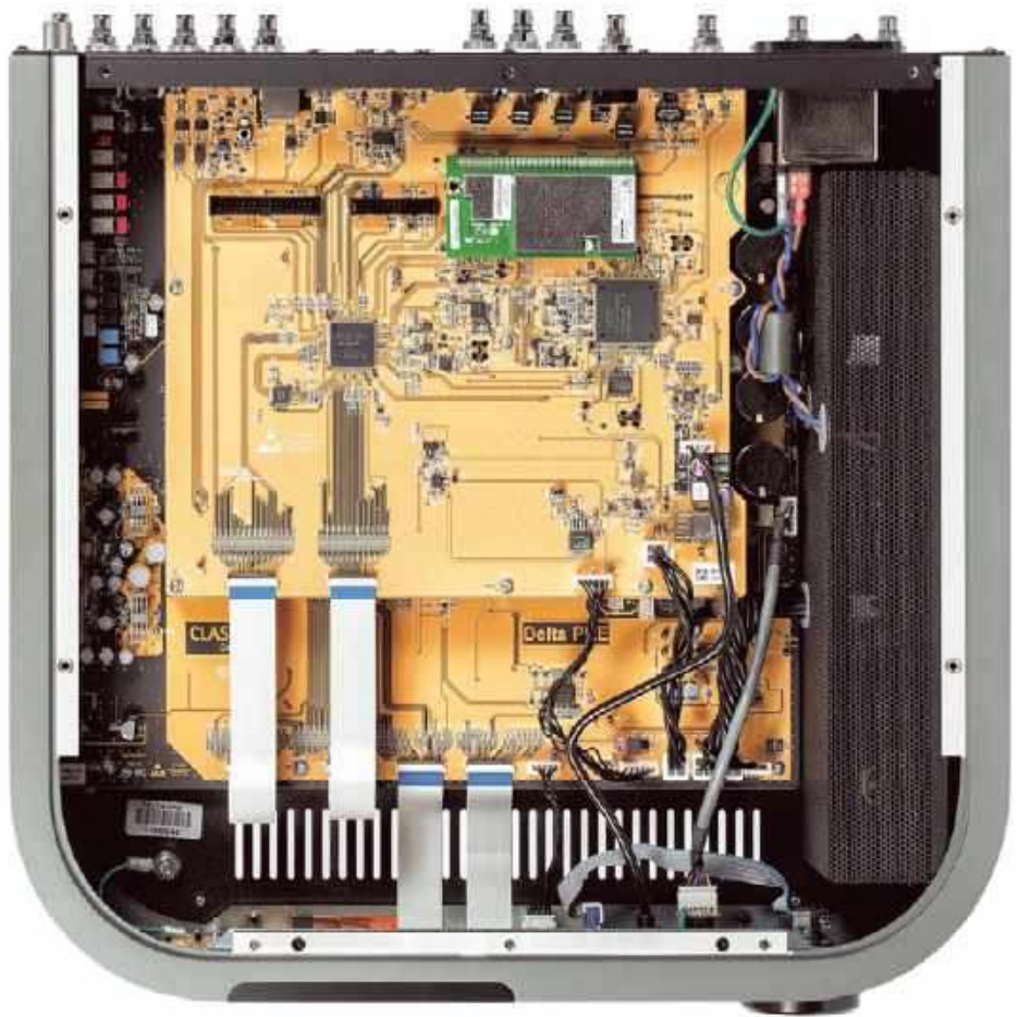
Układy ulokowano na dwóch dużych płytkach ustawionych jedna nad drugą, z ekranowaniem zarówno zasilacza, jak i modułu sieci.
