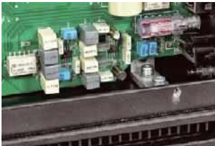
Przedwzmacniacz gramofonowy we wzmacniaczu Regi to rzecz – na szczęście – oczywista, choćby miało być proste układ na scalakach.
