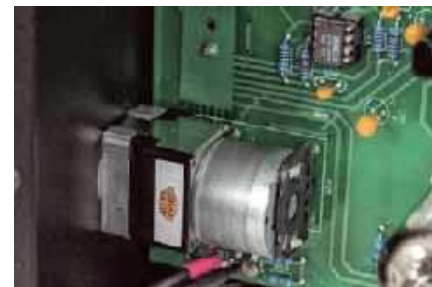
Regulacja wzmacnienia to domena japońskiego Alpsa.
