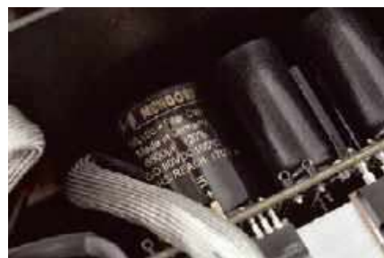
W sekcji zasilającej każdej z końcówek zastosowano kondensatory Mundorf MLYtic AG+.
