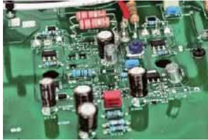
Główną płytkę wykonano w technice SMD, która pozwoliła na skrócenie ścieżki sygnałowej i osiągnięcie bardzo dobrego odstępu od szumu.
