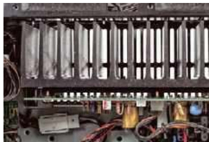
Każda końcówka mocy ma kompletny układ z radiatorem i płytką drukowaną.
