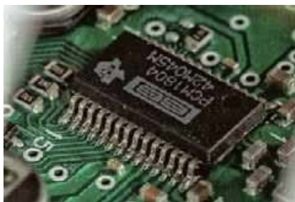
Sekcja analogowa została sprowadzona do absolutnego minimum, ponieważ sygnał jest konwertowany niemal natychmiast do postaci cyfrowej. Za te operacje odpowiada układ Texas Instruments.
