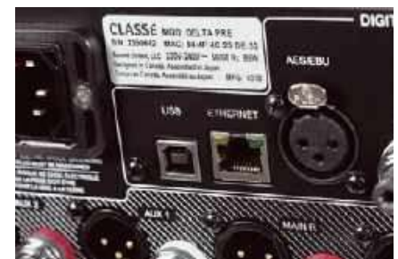
W sekcji cyfrowej błyszczy jak zwykle wejście USB-DAC, które przyjmie tutaj sygnały PCM 32/384 oraz DSD256.
