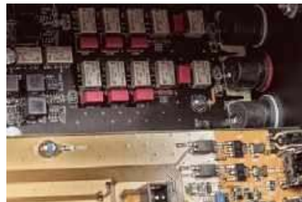
Oprócz wielu nowoczesnych cyfrowych układów, w Delta PRE są także bardziej konwencjonalne – wybór wejść odbywa się z pomocą przełączników.
