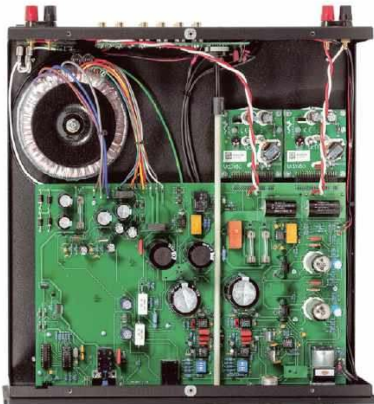
Impulsowo-lampowo-tranzystorowa kombinacja bazuje na gotowych modułach końcówek mocy, pozostałe układy zaprojektował Rogue Audio.
