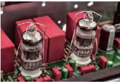
Dwie podwójne triody 12AU7 pracują w lampowym układzie wyjściowym.
