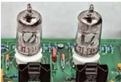
Podwójne triody w przedwzmacniaczu pochodzą z firmy PrimaLuna.
