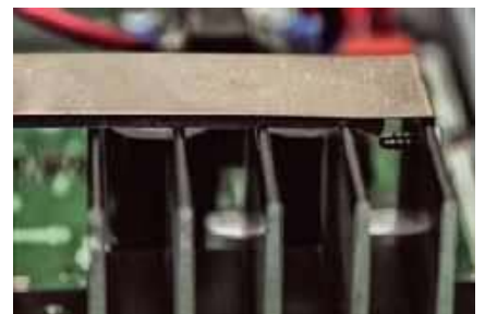
Miło popatrzeć na takie detale: na niewielkie radiatora (końcówek mocy) nakleiono paski tłumiące wibracje.
