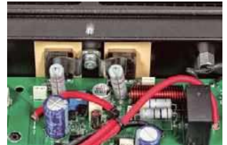
Końcówka mocy to układ w klasie AB z jedną parą wydajnych tranzystorów Sankena.
