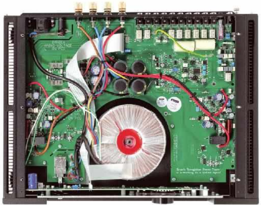
Układ audio skoncentrowano na jednej płytce drukowanej, nowoczesna regulacja głośności pozwoliła skrócić ścieżkę sygnałową, jednak ustalenie bardzo wysokiej czułości obniżyło odstęp od szumu.
