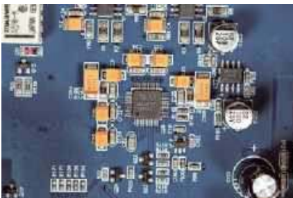
Przetwornik C/A to jeden z najnowszych układów tego typu – AKM AK4493.
