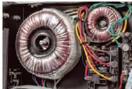
Układy cyfrowe mają niezależny zasilacz.
