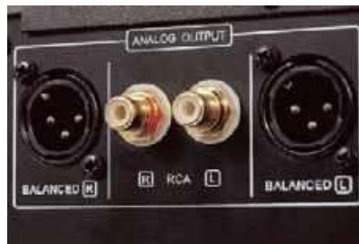
Analogowe wyjścia są dostępne w standardach RCA i XLR. Warto korzystać z tego drugiego, gdyż sekcja analogowa przetwornika jest torem zbalansowanym.
