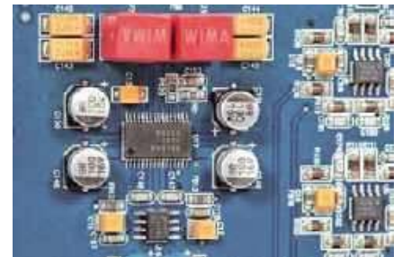
Wobec zapowiadanego zaawansowanego systemu regulacji głośności zaskakuje obecność popularnego scalaka NJR MUSES.
