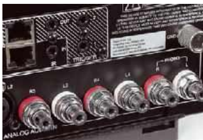
Wśród wejść analogowych największe wrażenie robi phono z regulowanymi parametrami dla wkładek MM i MC.
