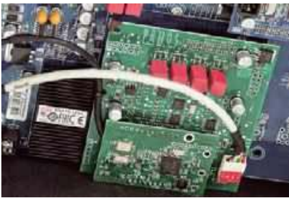
Oznaczenie HiDAC to nazwa modułu przetwornika, który Pathos instaluje również jako rozszerzenie wzmacniacza.
