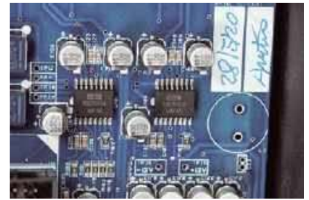
Właściwa regulacja głośności odbywa się w dwóch stereofonicznych, scalonych tłumikach.
