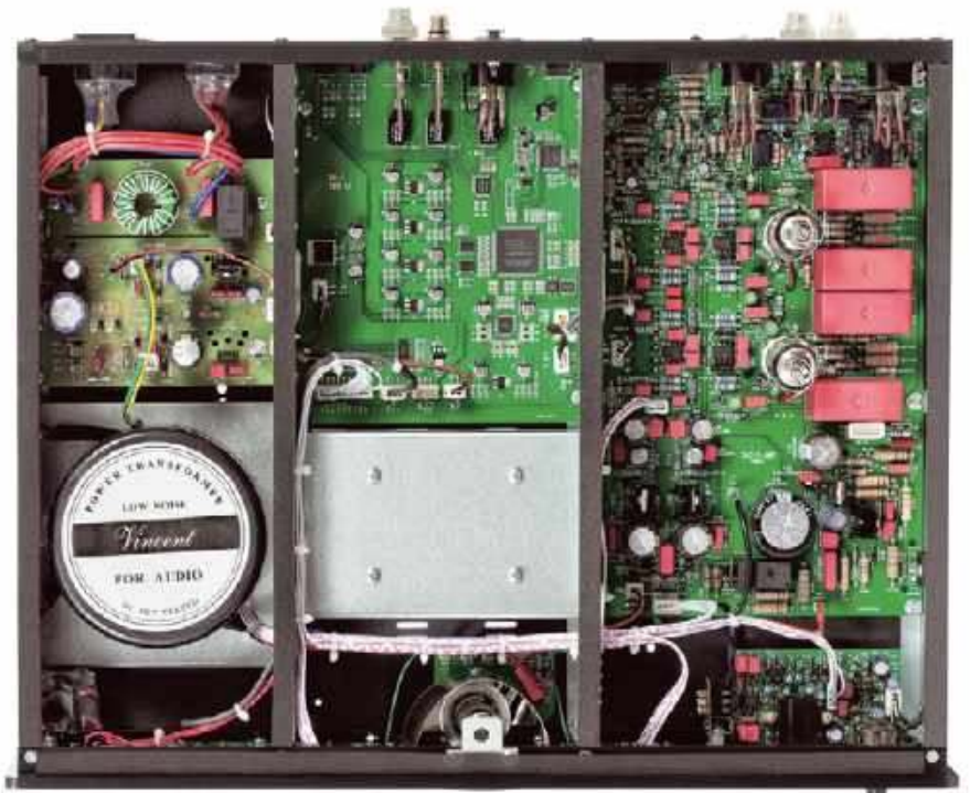
Układy pogrupowano w trzech dużych komorach, oddzielając zasilacz, elektronikę cyfrową i układy analogowe.
