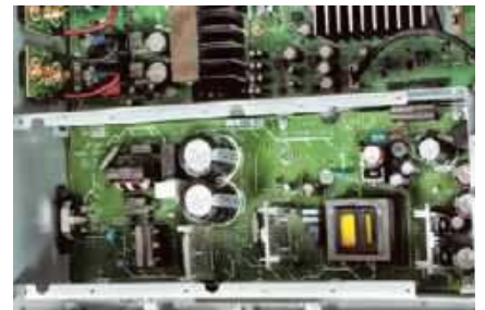
Technics zaprojektował też własny impulsowy tor zasilający z rozbudowaną filtracją napięcia wejściowego i wyjściowego.
