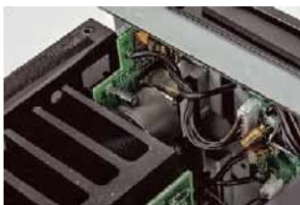
Regulacja głośności – znowu bardzo klasycznie – z potencjometrem Alpsa.
