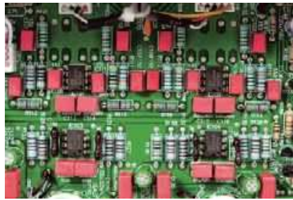
W sekcji półprzewodnikowej – wzmacniacze operacyjne Burr Brown.
