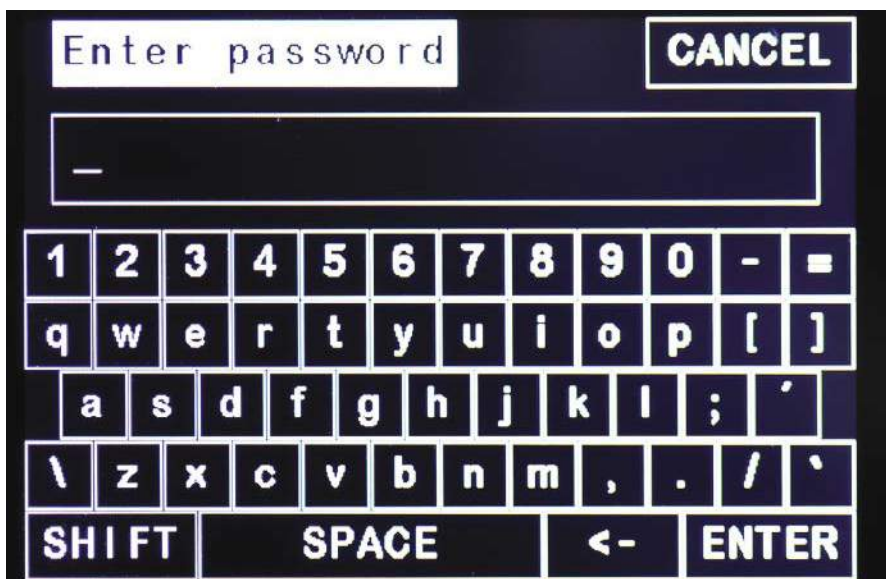
Zrzut ekranu 3. Zalety dużego ekranu dotykowego ujawniają się na stronie wpisywania hasła. Tutaj możemy wykorzystać dużą przestrzeń ekranu do emulacji pełnej klawiatury QWERTY, która umożliwia wprowadzanie wszystkich znaków ASCII. Większość klawiszy znajduje się w typowych miejscach; niektóre zostały przeniesione dla zachowania zwartości ekranu. Podobny ekran służy do wprowadzania lokalizacji miejsca odczytu pogody.
