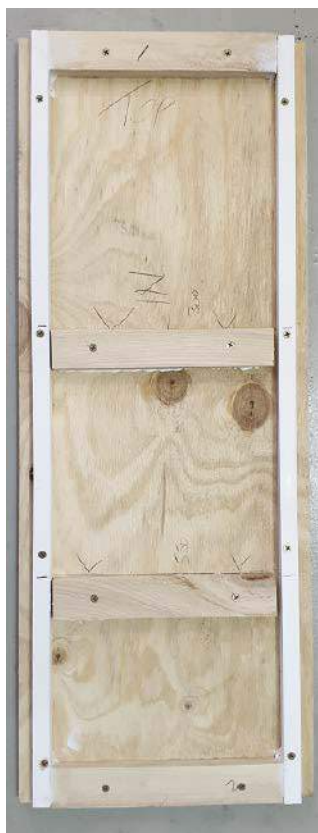
Rysunek 17. Panele subwooferów są wycięte z trzech arkuszy skleiki o wymiarach 600×1200 mm. Podobnie jak w przypadku monitorów, można przeciąć dwa arkusze przez środek. Aby nie trzeba było kupować czwartego arkusza na jeden panel przedni, ostatni element jest wykonany z jednego z odciętych arkuszy głośników półkowych (patrz rysunek 13, w poprzednim numerze EdW)
