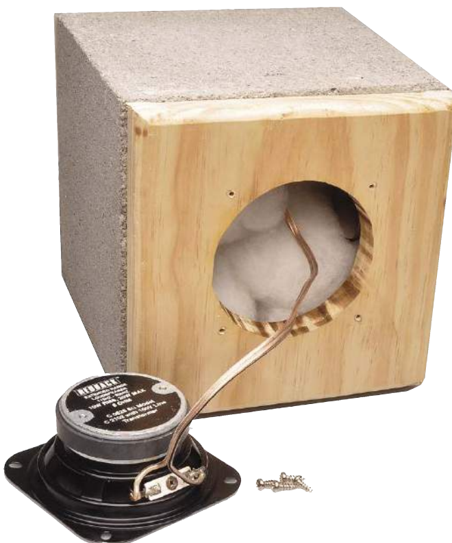
Widok z przodu pokazujący przedni panel przyklejony do pół-pustaka i watę akustyczną wewnątrz. Aby cztery tły śrub nie wyróżniały się tak bardzo, można pomalować je na czarno
