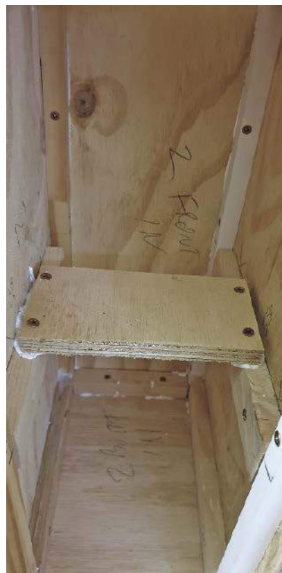
Rysunek 17. Panele subwooferów są wycięte z trzech arkuszy skleiki o wymiarach 600×1200 mm. Podobnie jak w przypadku monitorów, można przeciąć dwa arkusze przez środek. Aby nie trzeba było kupować czwartego arkusza na jeden panel przedni, ostatni element jest wykonany z jednego z odciętych arkuszy głośników półkowych (patrz rysunek 13, w poprzednim numerze EdW)
