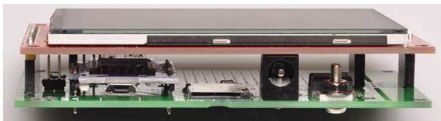
Kolejny widok na sposób współpracy naszej płytki z modulem ekranu dotykowego LCD – po prostu podłącza się ekran do 14-stykowego gniazda żeńskiego (CON1) skrajnie po lewej stronie i 4-stykowego gniazda (CON1A) po prawej. Zasilanie odbywa się przez gniazdo DC (CON3); obok znajduje się gniazdo karty microSD (CON2) z gniazdem USB pod modulem Wi-Fi (po lewej).
