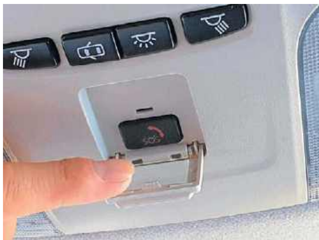
Przycisk jest połączony z GPS oraz czujnikami auta
