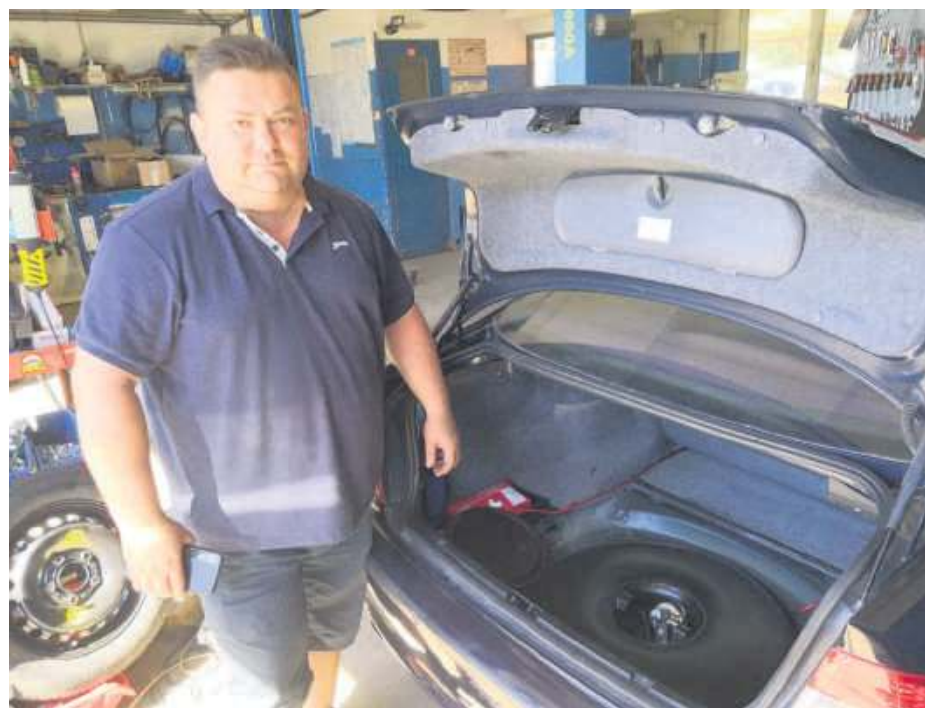
Pewnym minusem instalacji gazowych jest to, że gdzieś trzeba umieścić zbiornik. Często jest to, tak jak tu na zdjęciu, miejsce po kole zapasowym.
