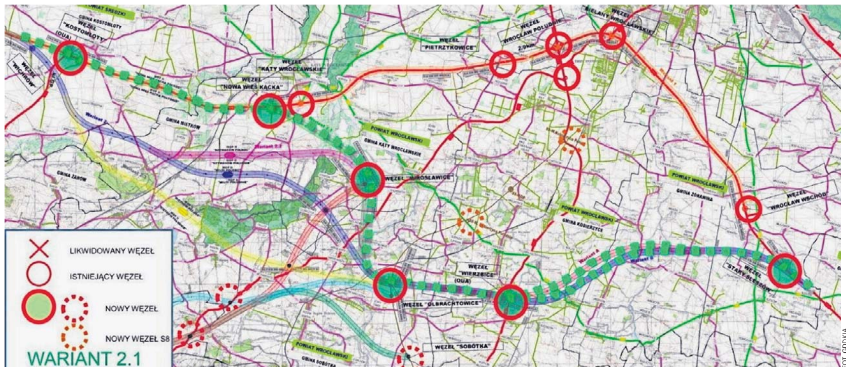
Pełny przekrój wariantu 2.1 zaznaczonego kolorem zielonym z czerwonymi kropkami. To fragment A4 od Kątów Wrocławskich po Wrocław Wschód, który zostanie zbudowany po nowym śladzie. Na całej długości mają powstać po 3 pasy w obu kierunkach z pasem awaryjnym
