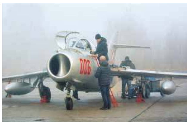
Ostatnie przygotowania przed odlotem. Dokonano sprawdzeń technicznych maszyny i próby silnikowej
