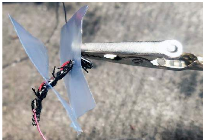
Fotografia 1. Przekładki izolujące ogniwa od siebie
