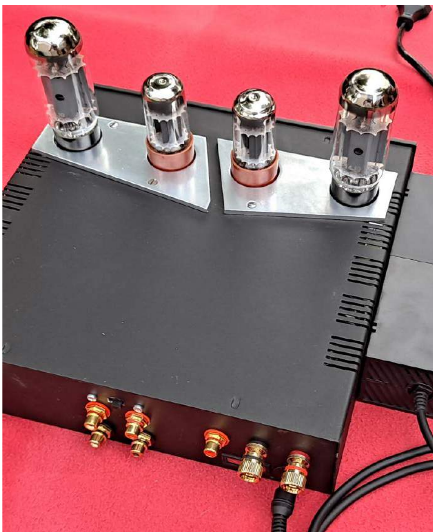
Fotografia 3. Wygląd gotowej konstrukcji z dołączonym zewnętrznym zasilaczem
