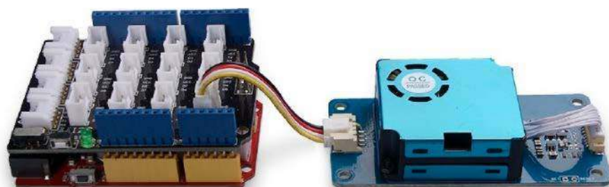
Fotografia 1. Moduł podłączony do Arduino przez płytkę Grove Base Shield
