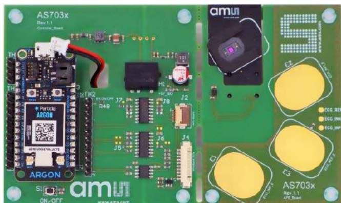
Fotografia 3. Widok zestawu ewaluacyjnego dla układów z serii AS703x z podłączonym modułem, wyposażonym we wbudowany front-end (czarna płytka po prawej stronie PCB, https://bit.ly/3pmZw8K )
