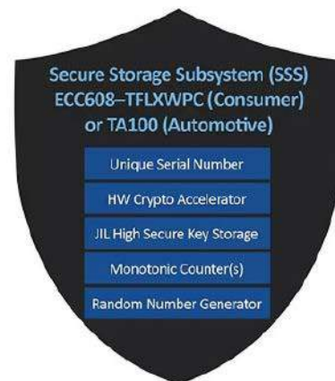
Rysunek 1. Wbudowana funkcja klucza wymaga bezpiecznego układu, który przechowuje krytyczne informacje oddzielnie od głównego procesora urządzenia
