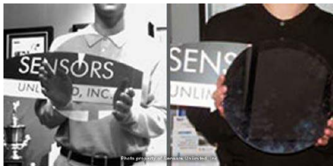
Fotografia 4. Przejrzysty w podczerwieni substrat krzemowy – materiał ten nie nadaje się do produkcji sensorów IR, ale może być użyty do wykonania optyki do systemów termowizyjnych. Po lewej widoczne jest zdjęcie w podczerwieni, a po prawej stronie to samo, ale wykonane zwykłym aparatem w świetle widzialnym
