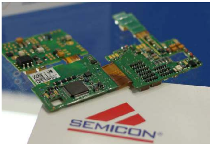
Fotografia 13. Płytki w technologii Flex-Rigid, produkowane przez Semicon. Płytki są po montażu pokryte powłoką konformalną, która zabezpiecza je przed wilgocią itp.
