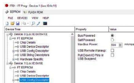
Rysunek 4. Konfiguracja prądu portu USB w programie FT Prog
