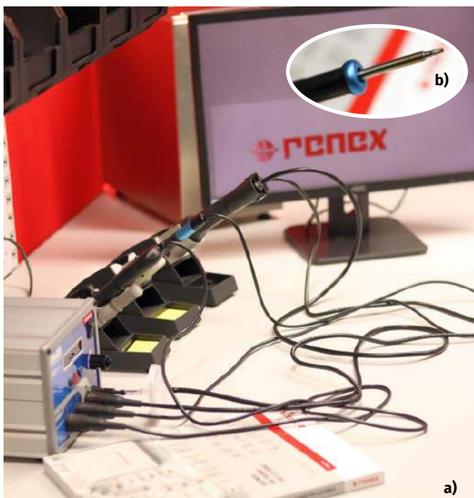
Fotografia 12. a) Stacja lutownicza Pace MBT-360 z rączką TD-200, termopęsetą MT-200 i rozlutownicą SX100; b) Zbliżenie na grot z technologią AccuDrive w rączce TD-200
