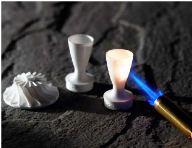
Fotografia 2. Wydruki z żywicy z dodatkiem ceramicznym firmy Formlabs. Detale po wygrzaniu w piecu – widoczne są wysokie parametry termiczne detalu
