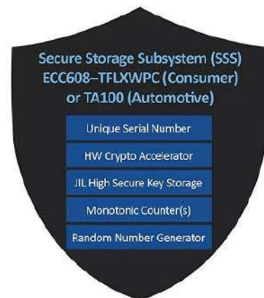
Rysunek 1. Wbudowana funkcja klucza wymaga bezpiecznego układu, który przechowuje krytyczne informacje oddzielnie od głównego procesora urządzenia
