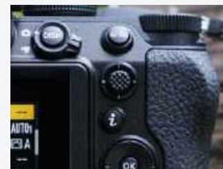
Joystick Pozwala na szybką i wygodną zmianę punktu ostrości bez odrywania oka od wizjera
