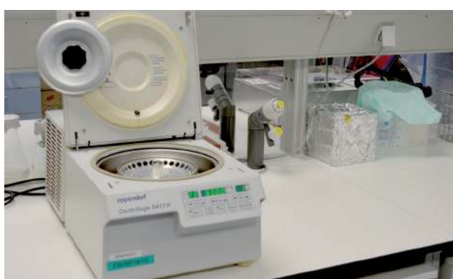
Laboratoryjna ciekawostka – urządzenie nazywane centryfugą albo wirówką, służące do rozdzielania zawiesin i emulsji. Wprowadzając próbki w szybki ruch obrotowy, wielokrotnie zwiększa się szybkość sedymentacji danej substancji, czyli wytrącania osadu
