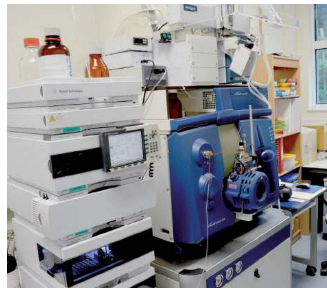
W PIWecie znajduje się wiele specjalistycznych i kosztownych urządzeń. Koszt zakupu niektórych z nich kilkakrotnie przewyższa cenę samochodu dobrej klasy. Na zdjęciu jedna z maszyn w Zakładzie Farmakologii i Toksykologii – chromatograf cieczowy sprzężony z tandemową spektrometrią mas. Służy do jednoznacznego identyfikowania substancji i oznaczania ilościowego próbek żywności
