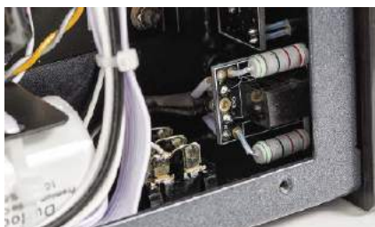
Wyjście słuchawkowe podłączono do końcówek, niezbędne było więc zastosowanie dzielnika napięcia (stąd obecność rezystorów dużej mocy).
