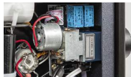
Regulacja głośności jest klasyczna – z potencjometrem Alpsa.
