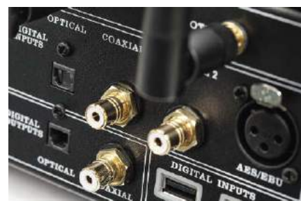
Wejścia współosiowe, optyczne i AES/EBU to wciąż obowiązkowe wyposażenie, i chociaż coraz mniej ważne dla źródeł sieciowych, to dzięki nim można wykorzystać wbudowany (doskonały) przetwornik C/A do poprawy brzmienia np. odtwarzacza CD.
