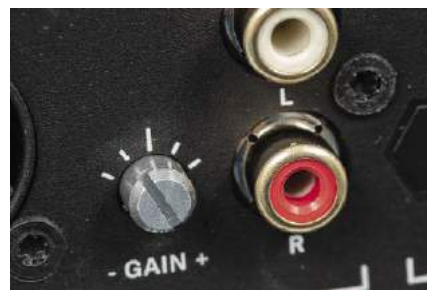
Niewielkie pokrętko w pobliżu wejść analogowych pozwala wybrać jeden z kilku trybów czułości.
