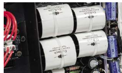
W całym układzie widać dużo elementów pasywnych wysokiej jakości, takich jak np. kondensatory DuRoch.
