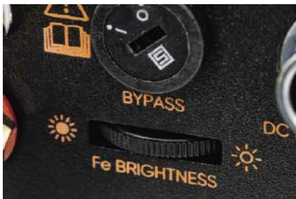
Niewielkim pokrętkiem możemy regulować intensywność podświetlenia logo (z przodu).
