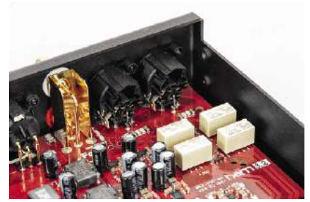
W przełączaniu funkcji dla sygnałów audio (np. wybór źródeł) pośredniczą przełączniki.
