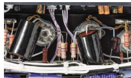
W okolicach lamp dominują połączenia punkt-punkt, pozostałe układy zmontowano na płytkach drukowanych.
