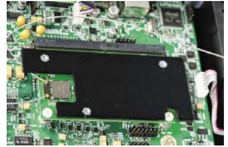
Widoczna w centrum dodatkowa płytką zawiera układy komunikacji bezprzewodowej, zaś anteny wklejono w boczne ścianki.
