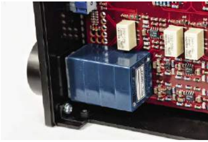
Poczwórny potencjometr potwierdza utrzymanie zbalansowanego toru sygnału.
