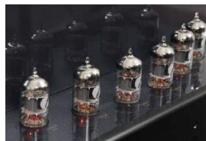
Przedwzmacniacz jest lampowy, pracuje tutaj w sumie aż sześć lamp.
