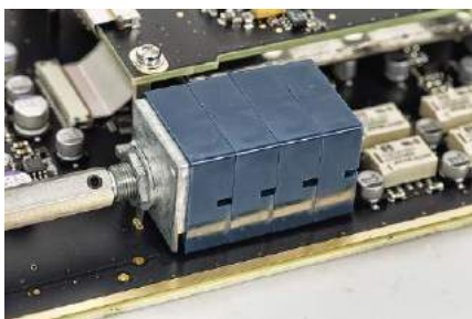
Częścią układu zbalansowanego jest poczwórny potencjometr analogowy.
