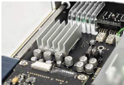
Wszystkie cztery wyjścia słuchawkowe obsługuje jeden wzmacniacz, minimalna impedancja obciążenia to 16 Ω.
