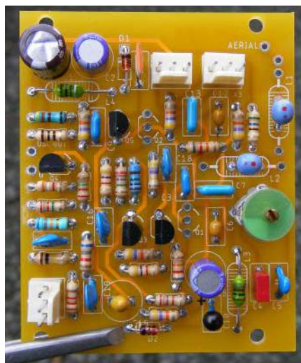
Rysunek 5. Płytkę drukowaną wysokości tonów – właściwie jest to Theremin jedynie z prostym strojeniem (ang. pitch-only) na jednej płytce.
