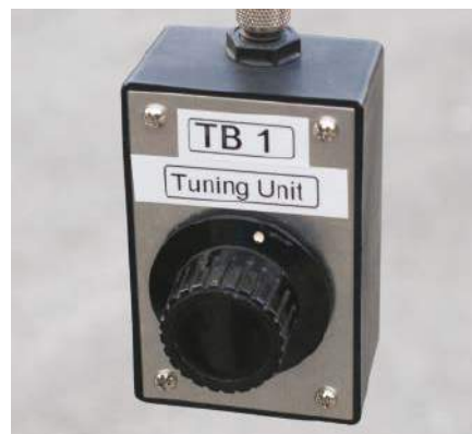
Rysunek 7. Umieszczenie potencjometru strojeniowego w małej skrzynce (połączonej kablem) poza anteną znacznie ułatwia strojenie Theremina.
