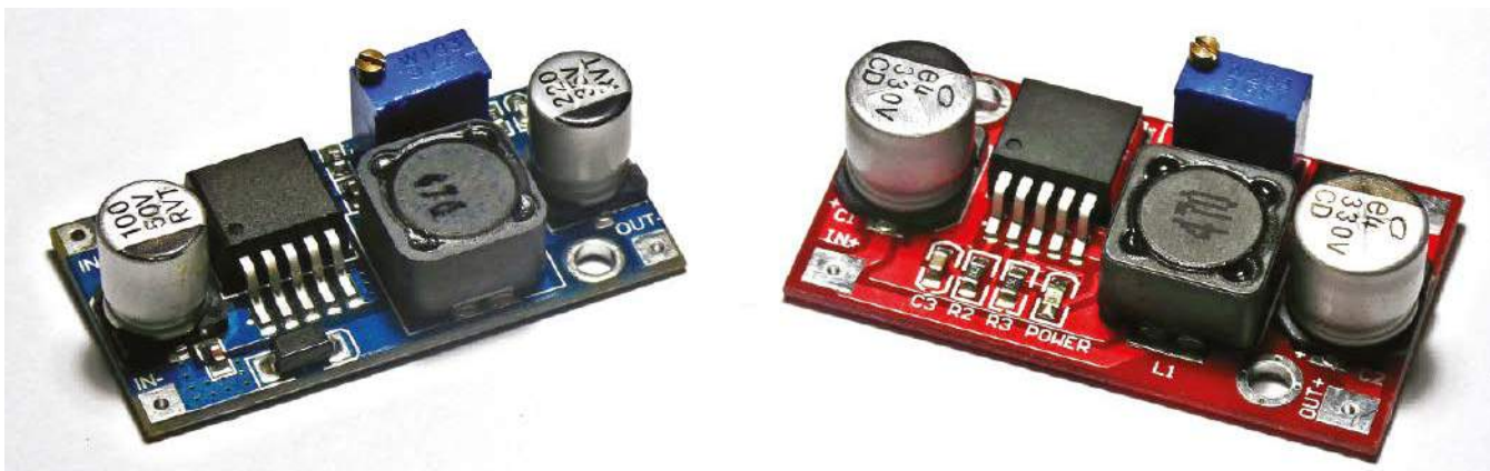
Rysunek 5.1. Niedrogie stabilizatory typu buck (L) i boost (R) są dostępne w sklepach stacjonarnych i online.
