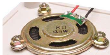
Trzy śrubki M3 z podkładkami i nakrętkami utrzymują głośnik na miejscu, jak pokazano tutaj.
