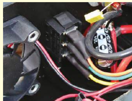
Rysunek 5.20. Oznaczenie przewodów kolorami ułatwia montaż i ewentualne poszukiwanie uszkodzeń.
