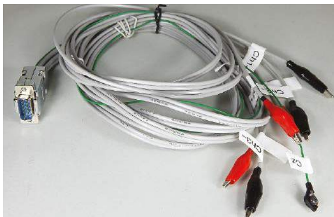
Na tym zdjęciu mamy sondy własnej roboty wykonane z użyciem klipsów-krokodyłków i dobrej jakości dwużyłowych kabli w ekranie, działają równie dobrze za ułamek ceny oryginalnych. Nie zapomnij o nalepkach-etykietach z naniesionymi numerami kanałów
