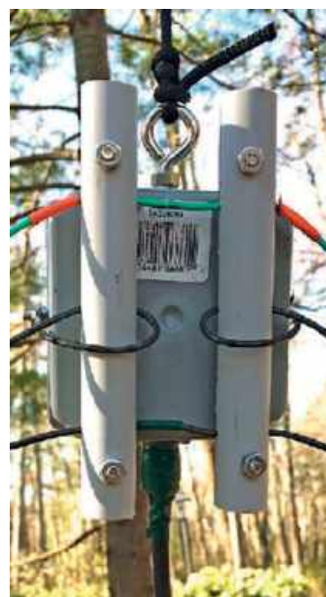
Skrzynka przyłączeniowa z symetryzatorem i dwoma rozpórkami z PCW
