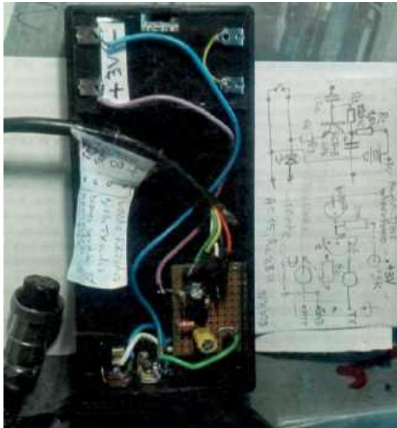
Rys. 3. Schemat przedwzmacniacza do mikrofonu elektretowego
