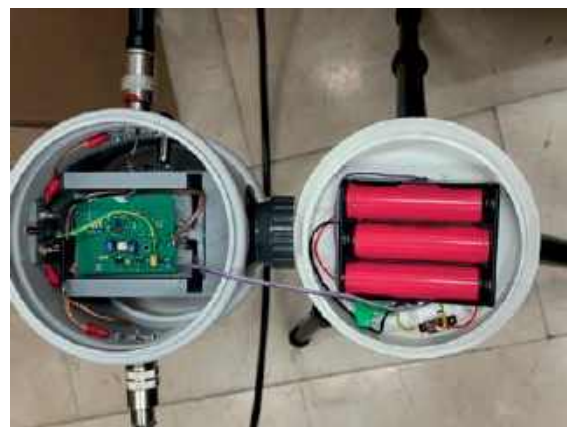
Widok dolnej części obudowy, pokazujący położenie ogniw zasilających 18650 Li-ion i płytki drukowanej wzmacniacza w podstawie kondensatora obrotowego
