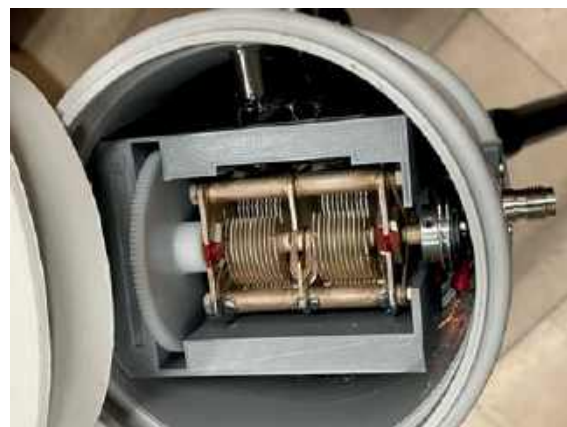
Widok obudowy z góry, przedstawiający kondensator tuningowy z przekładnią
