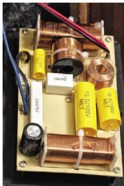
Zwrotnica SP 8 jest nieco bardziej skomplikowana prawdopodobnie z powodu dodania filtra linearyzującego impedancję (przy drugim bas-refleksowym wierzchołku), na który składa się dodatkowa cewka, kondensator (mały elektrolit) i rezystor.
