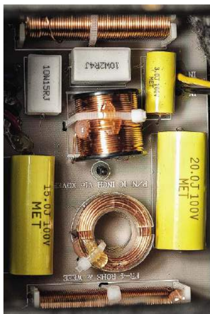
Zwrotnica SP 10. Liczba elementów LC (trzy cewki, trzy kondensatory), bez analizy połączeń, wskazuje na układ dwóch filtrów 3. rzędu (ale wraz z charakterystykami samych przetworników prawdopodobnie powstają zbocza akustyczne 4. rzędu).
