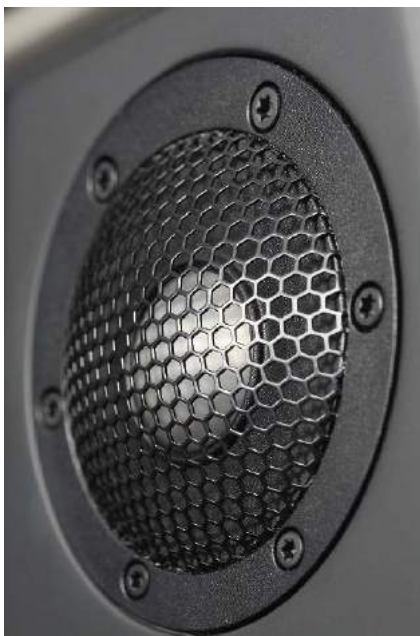
Berylowa kopułka wysokotonowa ma średnicę 34 mm i jest zasłonięta metalowym grillem wraz z dużą częścią frontu – to charakterystyczne cechy przetwornika BlieSMA.
