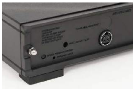
Zasilacz-sterownik (obrotów) umieszczono w niezależnej obudowie.
