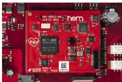
Autorskie algorytmy filtrów cyfrowych wykonuje moduł o nazwie Serce i zawarty w nim procesor ARM.
