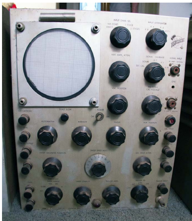
Rysunek 4. Tektronix 511 (1947) – pierwszy oscyloskop ze stabilnym wyzwalaniem ( triggered sweep ). Pasmo 10 MHz, masa ok. 30 kg, cena 795 USD. Źródło: https://w140.com/tekwiki/wiki/511
