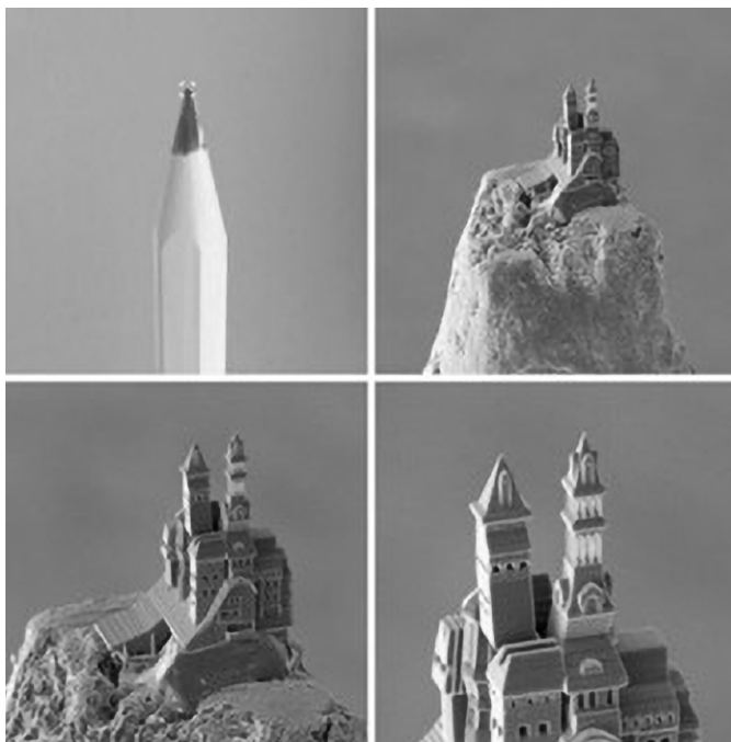
Zamek, mierzący zaledwie 6 milimetrów wysokości, na czubku ołówka, wydrukowany w systemie druku NanoOne, zachwyca niezwykle drobnymi szczegółami © UpNano GmbH
