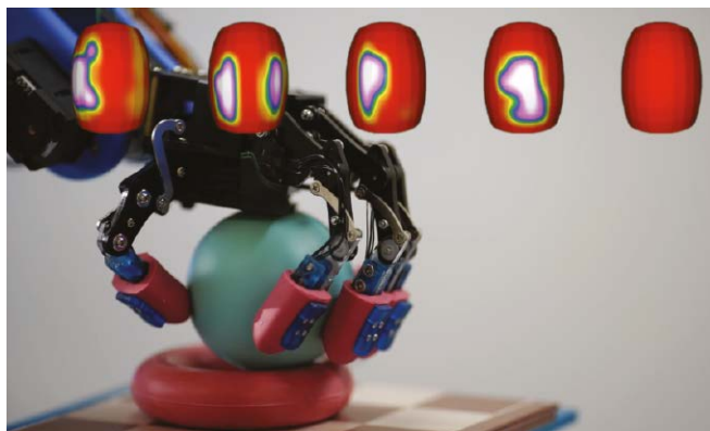
Rysunek 1. Ręka robota pokryta materiałem BeBop RoboSkin, podnosząca piłkę (zdjęcie: BeBop Sensors)
