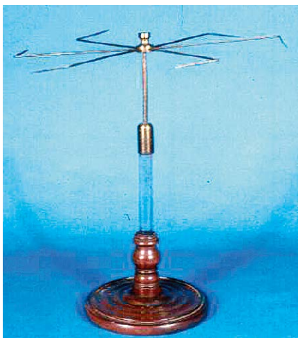
Rysunek 3. „Młynek elektryczny” zbudowany na wzór wynalazku Andrew Gordona z 1745 r. Konstrukcja ta jest prezentowana na wydziale fizyki Uniwersytetu Washington and Lee. Źródło: http://physics.kenyon.edu/EarlyApparatus/Static_Electricity/Electric_Whirl/Electric_Whirl.html
