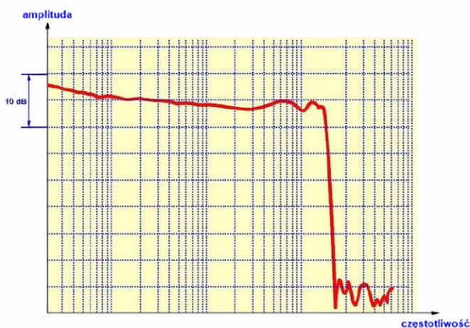
Charakterystyka amplitudowa filtra dolnoprzepustowego jedenastego rzędu (© 2019 Jos Verstraten)
