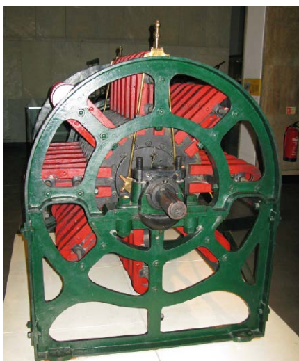
Rysunek 18. Generator Fredericka Hale'a Holmessa używany w latarni morskiej Souter. Źródło: https://www.wiki/7A2K (CC-BY-SA-4.0)
