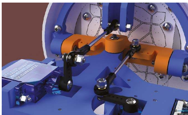
Rysunek 4. Każde animatroniczne oko (u góry) jest sterowane przez dwa serwomotory 9 g (zdjęcie: Steve Manley)
