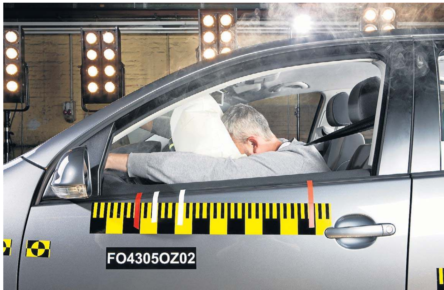
Poduszki, odpowiednio złożone i pokryte talkiem, ukryte są pod cienkimi warstwami tworzywa sztucznego. Oznaczane są skrótami SRS, SRS-Airbag lub Airbag, widocznymi w miejscach montowania. Po wystrzeleniu muszą zostać wymienione na nowe
