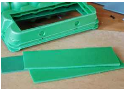
Płytki piankowe pozyskane z opakowań do jajek
