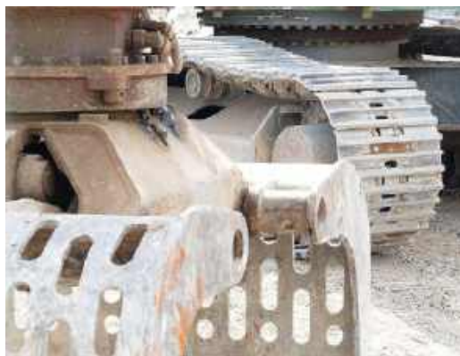
3. Gąsienice pojazdów wykonuje się z odpornej na ścieranie stali manganowej (pixabay.com)
