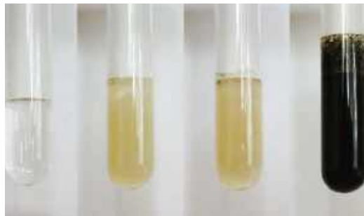
7. Wytrącanie i utlenianie wodorotlenku manganu(II). Od lewej kolejne etapy doświadczenia: z praktycznie bezbarwnego roztworu soli manganu(II) wytrąca się cielistej barwy wodorotlenek, który utlenienia się na powietrzu, a po dodaniu roztworu wody utlenionej szybko przechodzi w mieszaninę brunatnych połączeń na wyższych stopniach utlenienia
