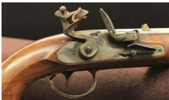
Zamek skałkowy i spust pistoletu Kentucky. W szczękach kurka zamocowano krzemień.
