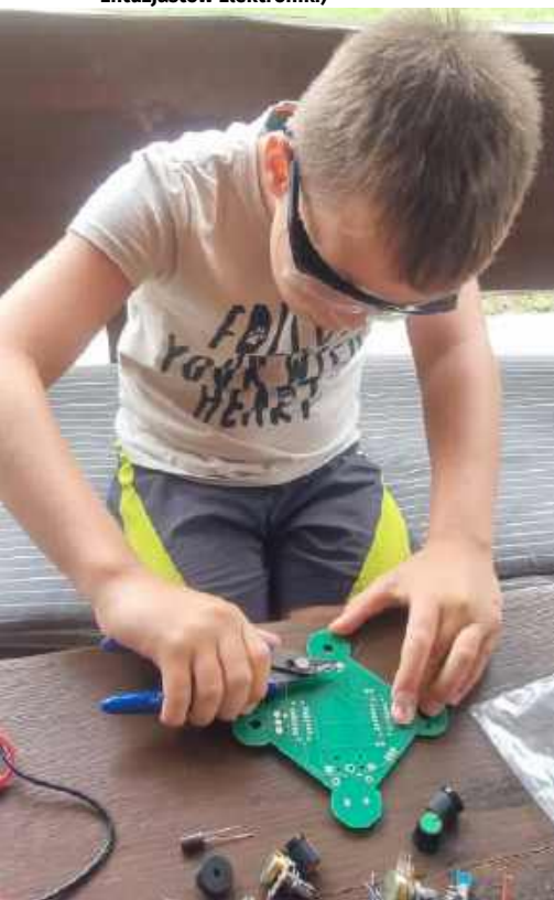
Fotografia 2. Obcinanie nadmiaru wyprowadzeń po przyłutowaniu rezystorów do PCB. Na zdjęciu Tymek (Wrocław, koło zainteresowań Młodych Entuzjastów Elektroniki)
