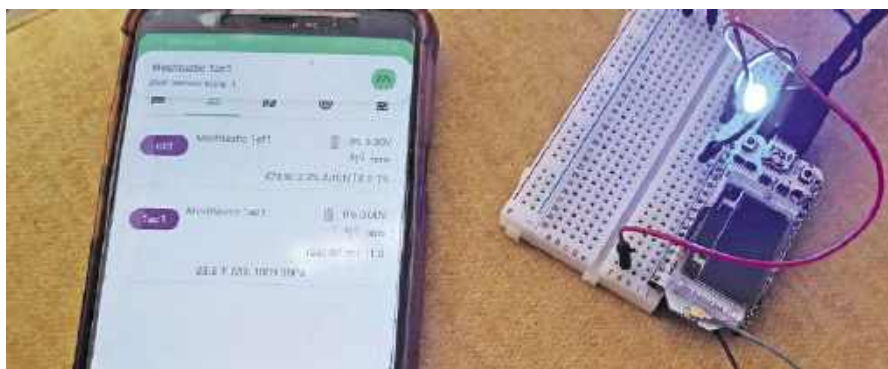
Fotografia 9. Włączony alarm LED
