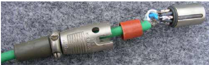
Rysunek 23. Mantra druciarza: nasuń wszystkie wymagane końcówki na kabel przed lutowaniem
