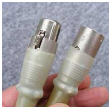
Rysunek 32. Jeśli używasz złączy ze śrubami, warto użyć koszulki termokurczliwej, aby je unieruchomić. Koszulka może też zapobiec zwarciom obudowy z innymi elementami
