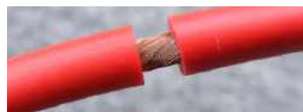
Rysunek 21. Zaskakująco eleganckie cięcie izolacji wykonane tanim narzędziem z niebieskim ostrzem z rysunku 20
