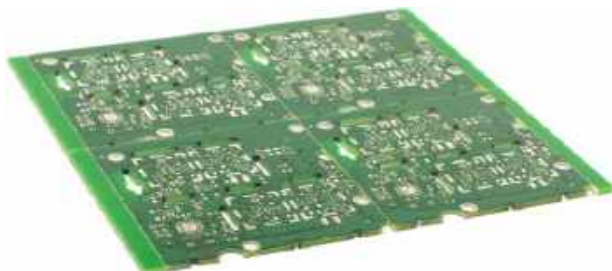
Płytkę PCB z dodatkowymi marginesami, dodanymi do projektu przez dostawcę usług PCBA z uwagi na komponenty SMD ustawione zbyt blisko krawędzi transportowych. Klient (z różnych względów) mógł działać świadomie, albo też nie wziął pod uwagę wymagań transportowych dostawcy. Niezależnie od przyczyny, użyta powierzchnia laminatu zwiększyła się, a koszt PCB w przeliczeniu na jedną sztukę płytki wzrósł
