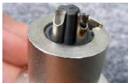
Rysunek 27. Czysty i ocynowany styk lutowniczy. Aby uzyskać najlepsze wyniki, należy użyć 3% aktywowanego lutu cynowo-ołowiowego 60/40 na bazie kalafonii. Zanieczyszczone topniki i europejskie lutowie bezołowiowe na bazie cyny nie są dobre. Najlepszy ze wszystkich lut to Multicore o niskiej temperaturze topnienia (LMP) z 2% zawartością srebra 62/36/2
