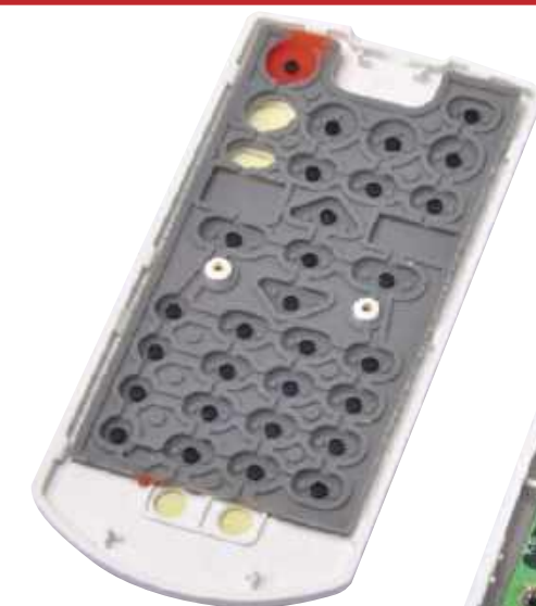
Przed zamontowaniem konwertera IR na UHF wewnątrz pilota należy sprawdzić, czy potrzebny jest rezystor ściągający sygnał sterowania diodą IR do masy
