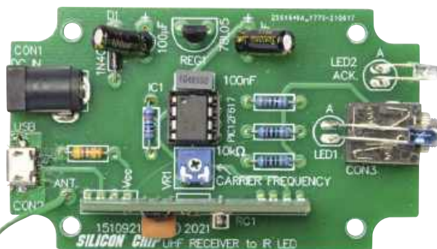
Rysunek 5. Montaż tej płytki jest prosty, ponieważ elementy są znacznie większe niż na drugiej płytce. Należy zwrócić uwagę na orientację odbiornika UHF, IC1 i diody D1
