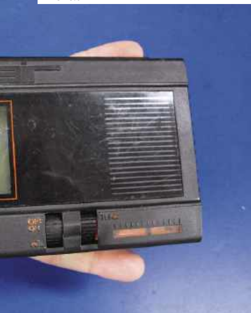
Rysunek 21. Płaski telewizor Sinclair TV80 CRT. Źródło: Wikimedia user Binarysequence, CC BY-SA 3.0
