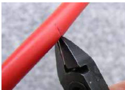
Rysunek 19. Cążki boczne mogą być używane do „nacinania” zewnętrznej powłoki w celu jej usunięcia – dobre do małych partii kabli
