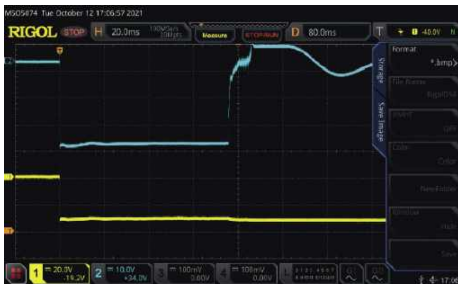
Oscylogram 1. Niebieski przebieg to napięcie na głośniku 4 Ω (zero woltów u góry), żółty przebieg natomiast to napięcie -34 V przyłożone do zabezpieczenia głośnika ze źródła zasilania. Głośnik zostaje odłączony w czasie krótszym niż 80 ms. Wtórne napięcie, którego można by się było spodziewać na skutek powrotu membrany do pozycji początkowej gdy przekaźnik rozłączy głośnik nie wystąpi, jeśli złącze CON8 zostanie podłączone do uziemienia. Dodatkowo membrana głośnika zostanie wyhamowana w pozycji początkowej
