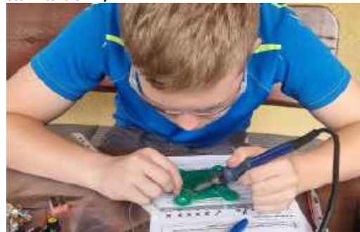
Fotografia 6. Lutowanie podstawek pod układy scalone do płytki. Na zdjęciu Łukasz (Wrocław, koło zainteresowań Młodych Entuzjastów Elektroniki)
