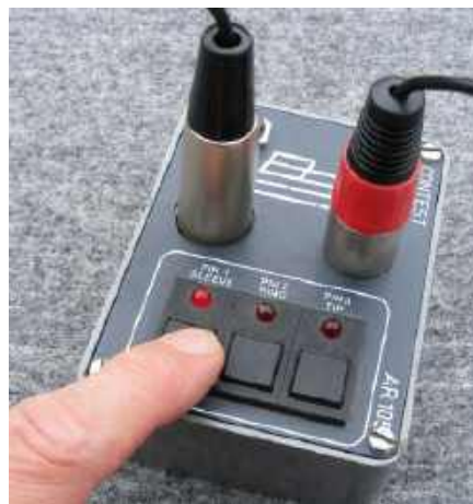
Rysunek 33. Jeśli wykonujesz wiele przewodów, tester kabli jest rozsądną inwestycją. To urządzenie BSS jest przeznaczone do testowania przewodów XLR i TRS jack
