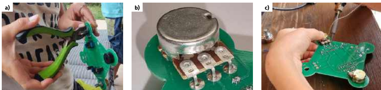
Fotografia 11. Przykręcenie potencjometru do płytki PCB (a), wycentrowanie potencjometru względem pól lutowniczych (b) oraz lutowanie wyprowadzeń uprzednio przykręconego do płytki i wycentrowanego względem padów potencjometru (c)
