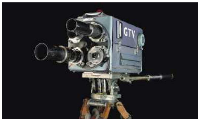
Rysunek 10(a) i (b). Kamera kineskopowa Pye Mk III, po raz pierwszy sprzedana w 1952 roku i używana do telewizyjnych transmisji testowych w Australii oraz do relacjonowania Igrzysk Olimpijskich w Melbourne w 1956 roku. Była wyposażona w silniki i mogła być zdalnie sterowana, w tym ustawiać ostrość, zmieniać obiektyw, a także przechylać i obracać za pomocą odpowiednich przystawek. Źródło: Australian Centre for the Moving Image, siliconchip.au/link/abf9
