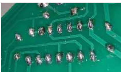
Fotografia 7. Obszar poprawnie przylutowanej podstawki układu scalonego do płytki PCB (przy założeniu, że podstawka została włożona do płytki zgodnie z oznaczeniem kierunku na warstwie opisowej)
