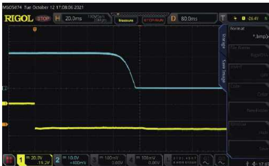
Oscylogram 2. Czas reakcji zabezpieczenia na napięcie 20 V DC. Krok napięcia wejściowego wynosi t=0 , a napięcie wyjściowe zaczyna spadać przed t=60 ms. Osiąga 0 V przed t=80 ms. Opóźnienie 80 ms wynika ze stałej czasowej RC filtra do osiągnięcia napięcia 0,6 V
