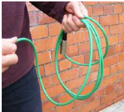
Rysunek 38. Technicy sceniczni nawijają kabel skracając nadgarstek podczas zwijania, aby zapobiec zagięciom
