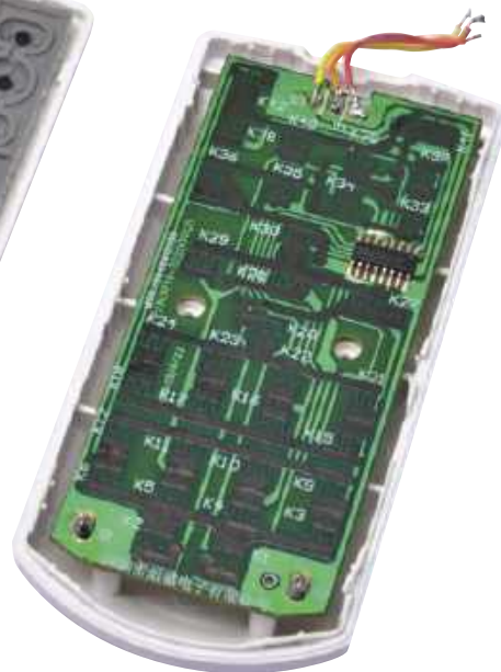
Przed zamontowaniem konwertera IR na UHF wewnątrz pilota należy sprawdzić, czy potrzebny jest rezystor ściągający sygnał sterowania diodą IR do masy
