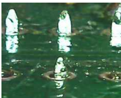
Fotografia 4. Niektóre z pinów układu scalonego nie przeszły na drugą stronę płytki PCB. Uczestnik zajęć tego nie zauważył i przylutował podstawkę, tworząc trudną do wykrycia usterkę
