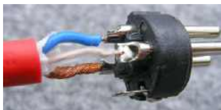
Rysunek 26. Tak powinna wyglądać prawidłowo przylutowana wkładka wtyku standardowego kabla mikrofonowego
