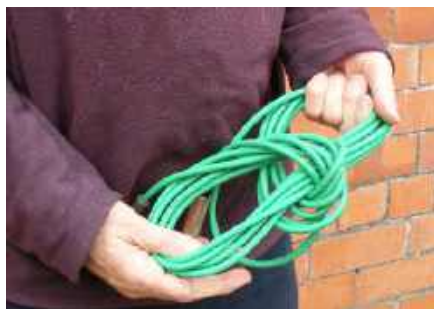
Rysunek 37. Związkiwanie kabla na czas przechowywania jeszcze bardziej naraża go na uszkodzenia
