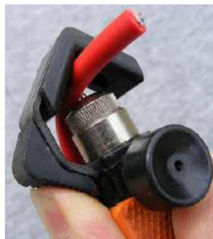
Rysunek 22. Narzędzie MK02 z obrotowym ostrzem. Okrągła tuleja umożliwia ustawienie głębokości cięcia, a czarny przycisk służy do zmiany kierunku ostrza
