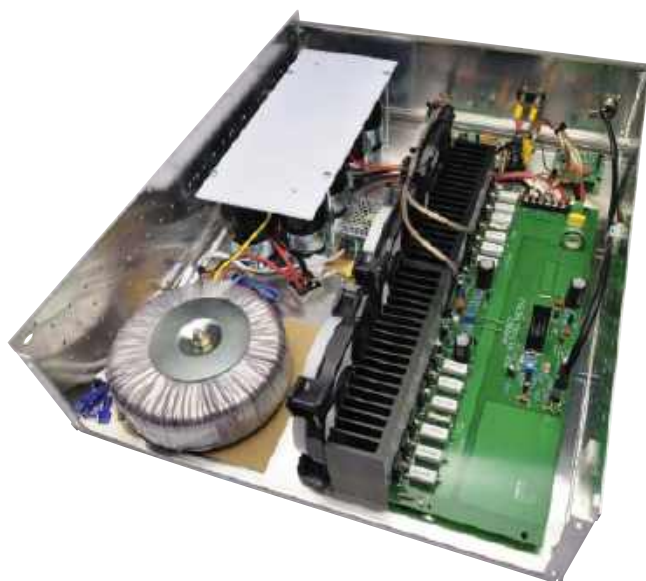
Gotowy moduł wzmacniacza zamontowany w obudowie 3RU z radiatorami i wentylatorami. Należy zwrócić uwagę na 120-milimetrowe wentylatory PWM przymocowane do radiatora, ponieważ większe nie zmieściłyby się w obudowie z założoną pokrywą
