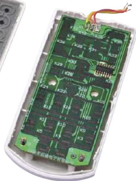
Przed zamontowaniem konwertera IR na UHF wewnątrz pilota należy sprawdzić, czy potrzebny jest rezystor ściągaający sygnał sterowania diodą IR do masy
