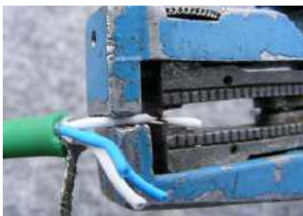
Rysunek 18. Efektywne zdejmowanie izolacji z przewodów sygnałowych wymaga dedykowanego narzędzia, które poradzi sobie z krótkimi przewodami. Używam tego AB Mk 1 od 1983 roku. Są one nadal dostępne w Grove Sales
