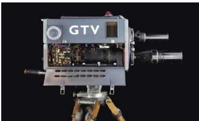
Rysunek 10(a) i (b). Kamera kineskopowa Pye Mk III, po raz pierwszy sprzedana w 1952 roku i używana do telewizyjnych transmisji testowych w Australii oraz do relacjonowania Igrzysk Olimpijskich w Melbourne w 1956 roku. Była wyposażona w silniki i mogła być zdalnie sterowana, w tym ustawiać ostrość, zmieniać obiektyw, a także przechylać i obracać za pomocą odpowiednich przystawek. Źródło: Australian Centre for the Moving Image, siliconchip.au/link/abf9
