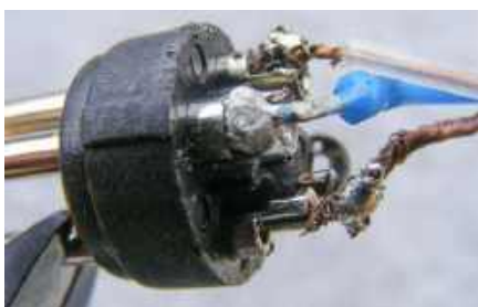
Rysunek 28. Jak tego nie robić. Wszystko, co mogło pójść źle, poszło źle: stopiona izolacja, niepoprawnie cynowane styki, szary bezołowiowy lut i zwarcia spowodowane luźnymi żyłami. Stały uczeń – praca na najniższą możliwą ocenę. Nie zaliczono
