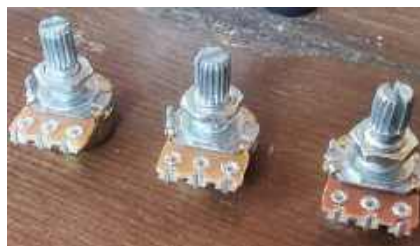
Fotografia 10. Potencjometry z wyprowadzeniami wygiętymi w stronę tulei regulacyjnych
