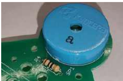
Fotografia 8. Montaż pasywnego buzzera piezo
