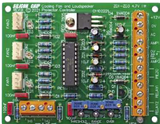
We wzmacniaczu 500 W zostały zastosowane dwa nasze poprzednie projekty: wentylator chłodzący i zabezpieczenie głośników (luty 2022; siliconchip.com.au/Article/15195 ) oraz wskaźnik przesterowania wzmacniacza (marzec 2022; siliconchip.com.au/Article/15240 )
