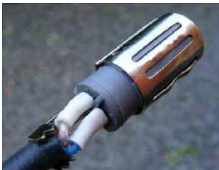
Rysunek 30. Białe koszulki silikonowe używane do zapobiegania zwarciom spowodowanym przez niezainstalowane żyły. Widok przed zaciśnięciem kabla. Jeśli dobrze lutujesz, nie jest to konieczne. Mogą przykrywać pęknięcia bądź luty słabej jakości
