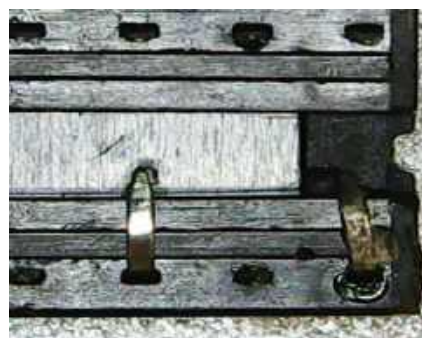
Fotografia 5. Podstawa po wylutowaniu z płytki. Dwa wyprowadzenia były zagięte i schowane pomiędzy podstawką a płytką drukowaną. Połączenie elektryczne nie mogło zaistnieć
