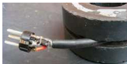
Rysunek 34. Stare magnesy głośnikowe są dobrym sposobem trzymania przewodów podczas cynowania i lutowania. Często używam również testera pokazanego na Rysunek 33 jako sposobu na trzymanie wkładek podczas lutowania
