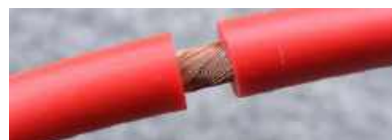
Rysunek 21. Zaskakująco eleganckie cięcie izolacji wykonane tanim narzędziem z niebieskim ostrzem z rysunku 20
