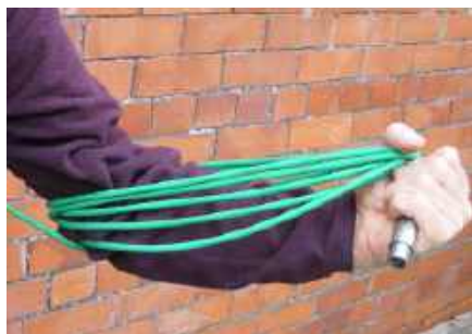
Rysunek 36. Nie nawijaj kabli w ten sposób, ponieważ powoduje to naprężenie przewodów
