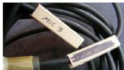
Rysunek 40. Wszystkie duże instalacje wymagają starannego oznakowania. Przydatne są te przypinane etykiety
