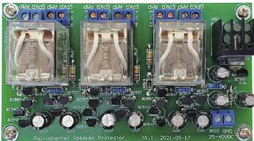
Płytkę ochraniacza głośników będzie wyglądać mniej więcej tak. Należy zwrócić uwagę na otwory wywiercone w płytce pod radiatorem, aby umożliwić konwekcję powietrza od spodu. W prototypowej wersji brakuje bloku zacisków CON8 (GROUND). Można go pominąć, ale jeśli zostanie dotknięte do uziemienia wzmacniacza, zapewni lepszą ochronę głośników
