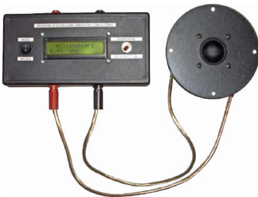
4. Urządzenie do wyznaczania temperatury cewki głośnika mierzące rezystancję uzwojenia cewki głośnika wysokotonowego typu GDWK 11/100 w temperaturze pokojowej
