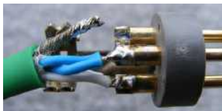
Rysunek 25. Przylutuj „gorący” przewód, podgrzewając styk wypełniony lutem. Następnie włóż „zimny” przewód i przylutuj. Na koniec przylutuj krótszy ekran, wciskając go, pozostawiając „luzy” w przewodach sygnałowych
