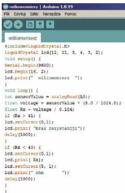
3. Kod źródłowy programu komputerowego urządzenia do wyznaczania temperatury cewki głośnika
