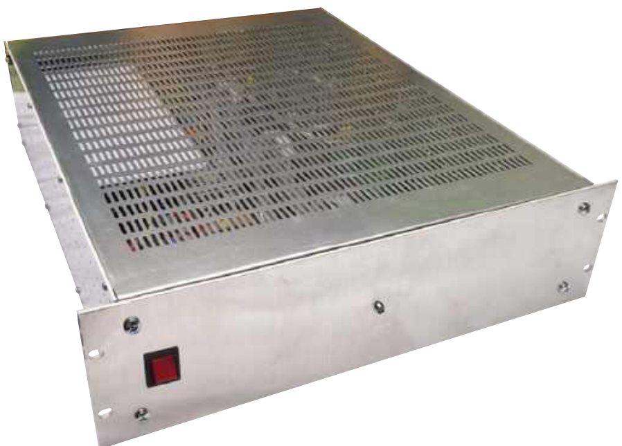
Gotowa obudowa jest bardzo prosta, zawiera jedynie przycisk zasilania i wskaźnik przesterowania LED z przodu oraz wejście/wyjście audio i gniazdo zasilania z tyłu
