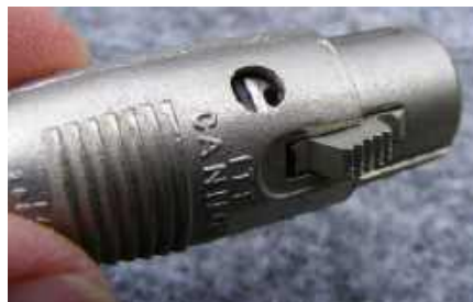
Rysunek 31. Najpierw należy dokręcić zacisk kabla przed całkowitym wsunięciem wkładki XLR (patrz otwór na śrubę). Gwarantuje to, że przewody sygnałowe nie są naprężone i nie ciągną za lut
