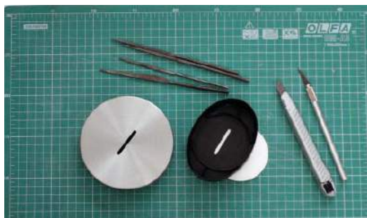
9. Wywiercić, wyciąć (choćby i nożykiem modelarskim) nie jest trudno – ale, by zachować elegancki wygląd otworu, trzeba zachować ostrożność, cierpliwość – i wspomóc się pilnikami igłowymi (typowymi lub samodzielnie przygotowanymi).
