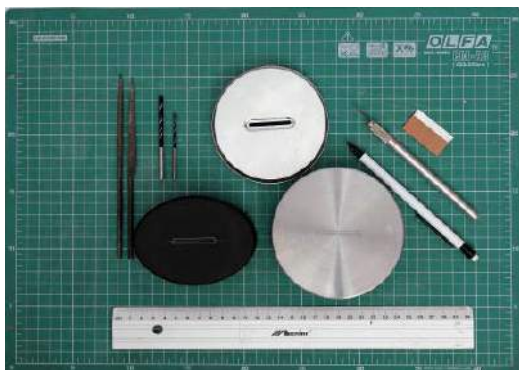
8. Otwór wrzutowy ma zwykle 3 do 4 na 35–36 mm i zaokrąglone końce. Niech będzie dokładnie taki pośrodku pokryw.
