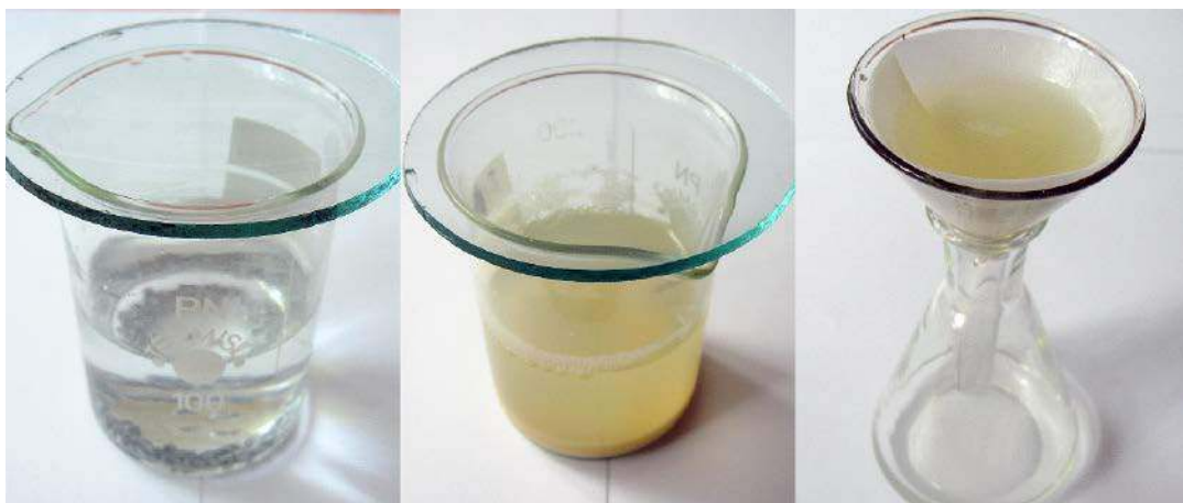
2. Od lewej: początek eksperymentu – drut lutowniczy zalany roztworem kwasu siarkowego, tworzące się związki cyny(IV) powodują zmętnienie zawartości zlewki, sączenie mieszaniny po reakcji.
