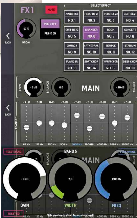
Ekran ustawień sekcji efektów i korektora, który może pracować w standardowym trybie graficznym lub w pełni parametrycznym dla każdego z pasm.
