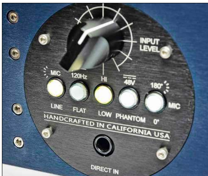
Potencjometr Input nie jest regulatorem wzmocnienia, ale tłumikiem. Czułość wejściową zmieniamy natomiast przyciskiem Hi/Low.
