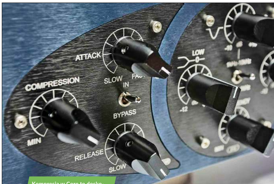
Kompresja w Core to doskonale znany i sprawdzony układ ELOP, oparty na konfiguracji optycznej.
