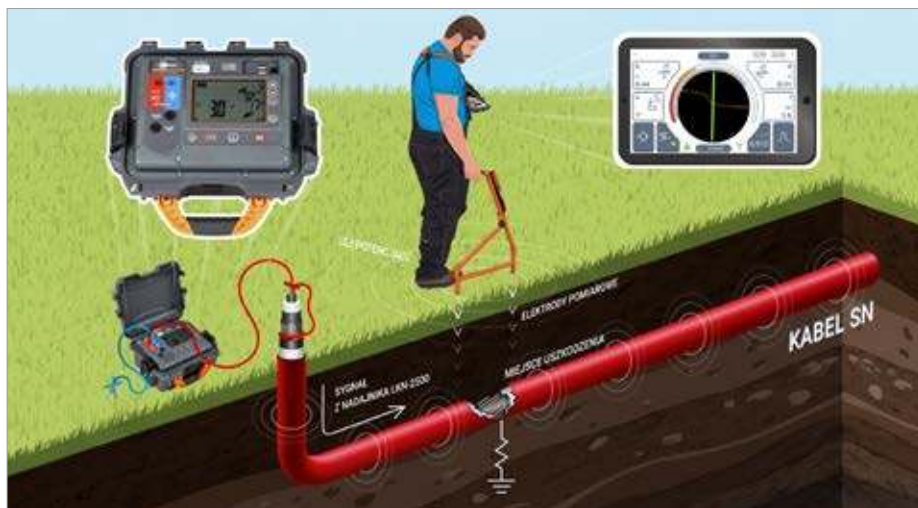
Rys. 2. Lokalizacja doziemienia przy wykorzystaniu Ramki A od Sonel
