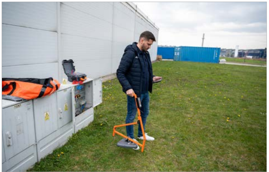
Fot. 1. Pomiary przy użyciu zestawu Sonel LKR-2500 Pro zawierającego Ramkę A
