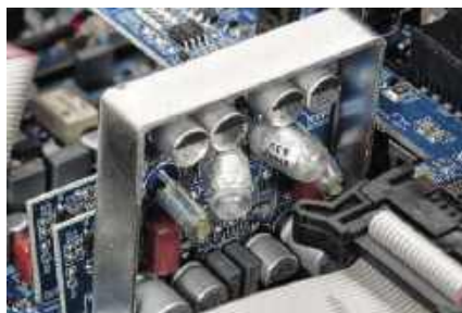
Przedwzmacniacz gramofonowy zajmuje niezależną płytkę, został zaekranowany ze względu na bliskość układów impulsowych,
