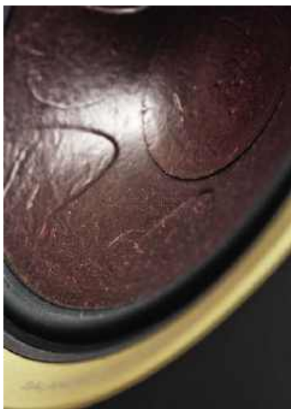
Celulozowa (z dodatkiem włókien drzewnych) membrana średniotonowego ma faliste przetłoczenia rozpraszające fale stojące i wąskie, niskostratne górne zawieszenie.
