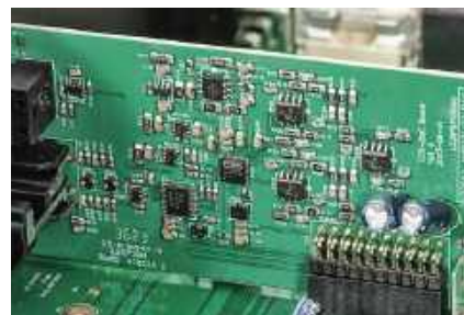
Sekcja cyfrowa opiera się na przetworniku ESS Technology ES9018.
