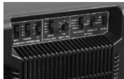
Przełączniki i regulatory podzielono na trzy grupy odpowiedzialne za wybór wejść i sterowanie, poziom czułości oraz korekcję częstotliwościową.
