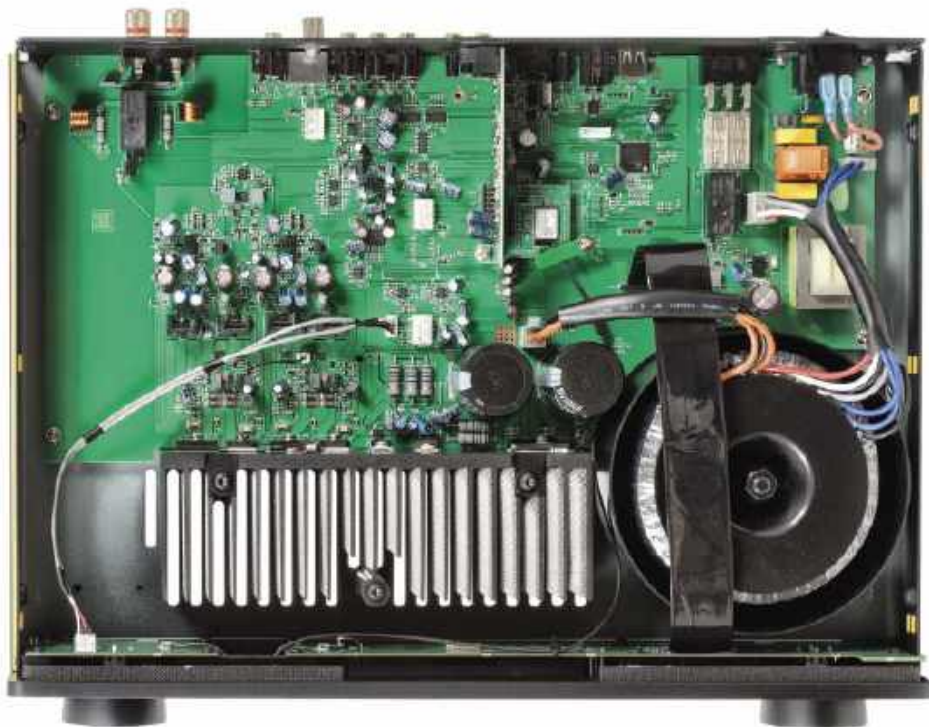
Cały tor sygnału utrzymano na jednej dużej płytce drukowanej – z wyjątkiem wyjścia słuchawkowego.
