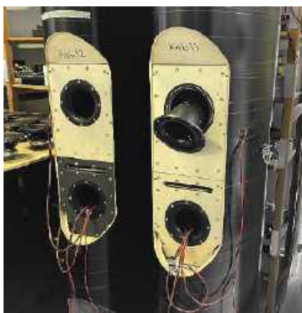
Obudowa przed założeniem tylnych żaluzji – dobrze widać zarówno tunele bas-refleks, jak i szczelinę komory średniotonowego.
