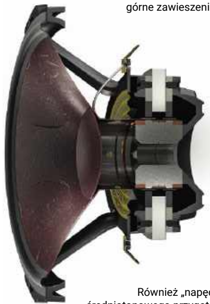
Celulozowa (z dodatkiem włókien drzewnych) membrana średniotonowego ma faliste przetłoczenia rozpraszające fale stojące i wąskie, niskostratne górne zawieszenie.
