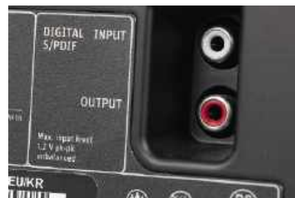
Para RCA to zestaw gniazd cyfrowych – wejście i wyjście współosiowe.
