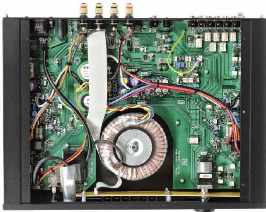
Płytkę audio rozciąga się na całą szerokość obudowy; do chłodzenia końcówek mocy wykorzystano boczne panele (gdzie przykręcone są tranzystory).
