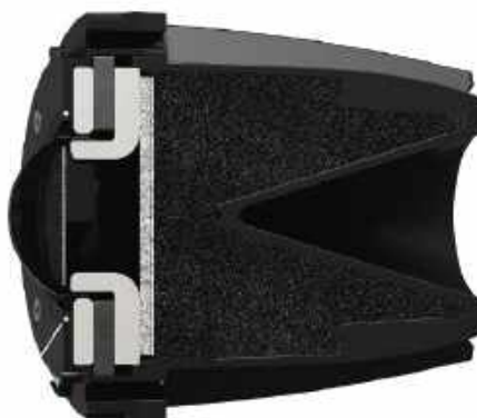
Większa (niż standardowo dla wysokotonowych) kopułka wymaga też większej komory utrzymującej niską częstotliwość rezonansową.
