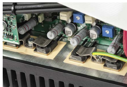
Końcówki mocy pracują w klasie AB, w każdym kanale dwie pary Sankenów.
