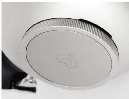
Pokrętła na zewnątrz muszli służą do regulacji głośności i przeskakiwania między ścieżkami.
