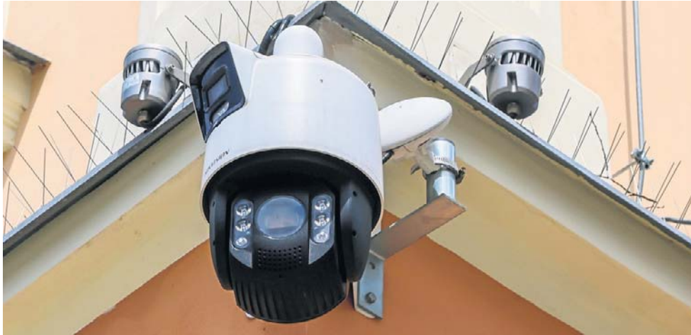
W czterech lokalizacjach pojawią się kamery 4K wyposażone w inteligentne funkcje analizy obrazu
