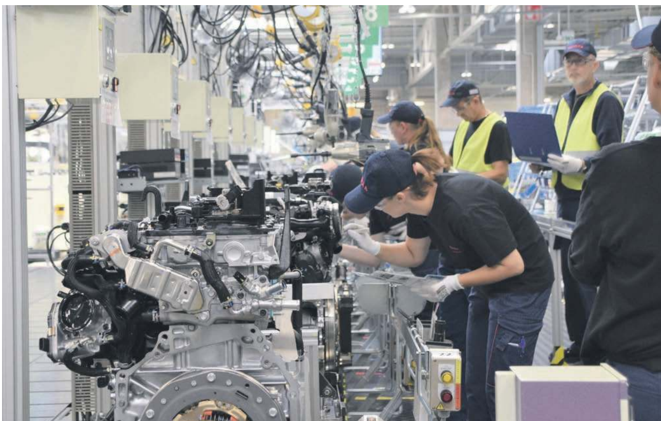
Linia montażu nowego silnika Toyoty o pojemności 2,0 l do napędów hybrydowych
