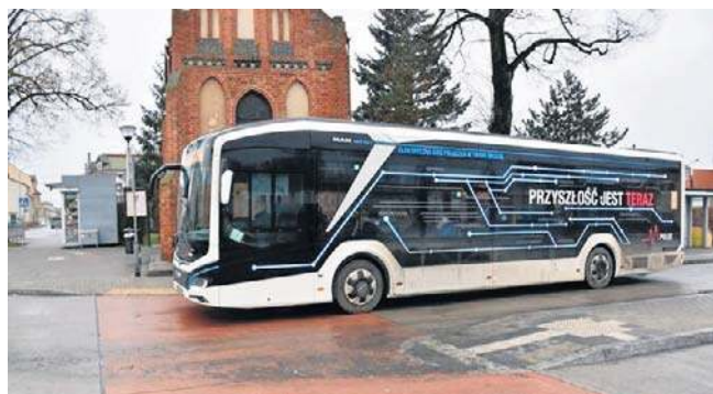
Elektrobus MAN był testowany w Policach. To pojazd o długości 12,2 m, wyposażony w 3 pary drzwi
