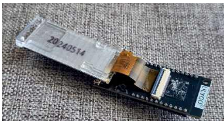
Moduł sprzedawany jest bez wlutowanych gold-pinów, może zająć konieczność, by do wlutowania gold-pinów do płytki ESP32-S3 odchylić wyświetlacz przyklejony do płytki
