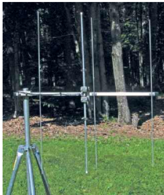
Antena Yagi na pasmo 2 m zamontowana w pozycji pionowej na trójnogu
