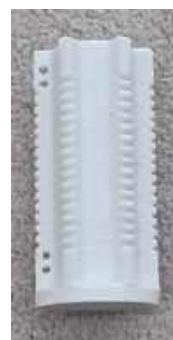
Karkas cewki generatora wydrukowany na drukarce 3D
