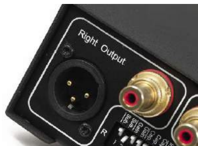
V10 ma wyjścia RCA oraz XLR (tutaj sygnał jest symetryzowany).
