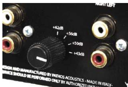
Regulację wzmacnienia umieszczono na tylnej ścianie.
