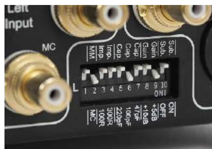
Mikroprzełączniki odpowiadają za większość ustawień, choć operowanie małymi hebelkami nie należy do najłatwiejszych.
