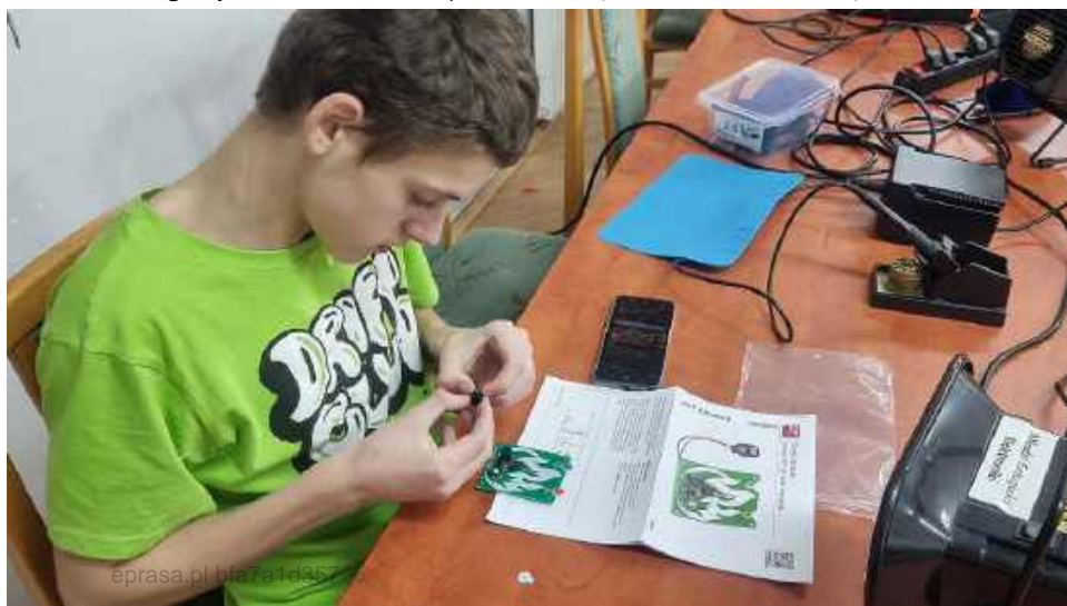
Fotografia 19. Kornel sprawdza znacznik kierunku montażu na obudowie układu scalonego przed zamontowaniem go w podstawce. Młodzi Entuzjaści Elektroniki, Szkoła Podstawowa nr 86, Wrocław
