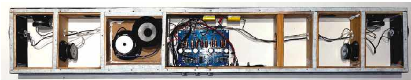
Moduł wzmacniacza włącznie z gniazdem wejściowym 3,5 mm jest montowany w otworze tylnego panelu za pomocą pustego laminatu PCB. W zestawie znajduje się przetątnik wyboru dla opcjonalnego zewnętrznego subwoofera i gniazdo zasilania 12...24 V. Gniazda bananowe są przeznaczone dla zewnętrznego subwoofera. Całe okablowanie należy unieruchomić za pomocą opasek zaciskowych i uszczelnacza silikonowego, aby zapobiec niepożądanym wibracjom
