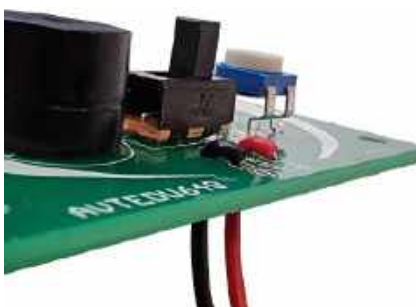
Fotografia 14. Kabelki złącza baterii należy przeprowadzić w otwory pomocnicze od strony lutowania a następnie odizolowane końcówki przewodów należy umieścić w otworach zgodnie z fotografią 13 i przylutować
