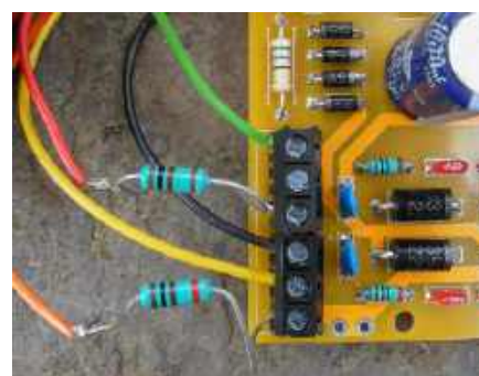
Rysunek 13. Przed pierwszym włączeniem zasilacza należy podłączyć rezystory ograniczające prąd 100 Ω między uzwojeniami wtórnymi 15–0–15 V a płytką drukowaną. Opcjonalnie można je później zastąpić bezpiecznikami przeciwprzepięciowymi 2 A
