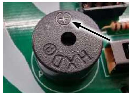
Fotografia 11a. Nadrukowana białą farbą na płytce PCB znak „+” wskazuje otwór w który należy zamontować „plusowe” wyprowadzenie buzzera aktywnego; b) znak „+” wskazujący lokalizację „plusowego” wyprowadzenia jest również wytłoczony w obudowie buzzera aktywnego, dołączonego do zestawu. Na powyższych fotografiach oznaczenia bieguny „plusowego” wskazane zostały strzałką
