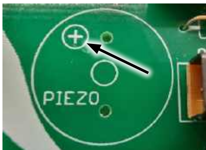
Fotografia 11a. Nadrukowana białą farbą na płytce PCB znak „+” wskazuje otwór w który należy zamontować „plusowe” wyprowadzenie buzzera aktywnego; b) znak „+” wskazujący lokalizację „plusowego” wyprowadzenia jest również wytłoczony w obudowie buzzera aktywnego, dołączonego do zestawu. Na powyższych fotografiach oznaczenia bieguny „plusowego” wskazane zostały strzałką
