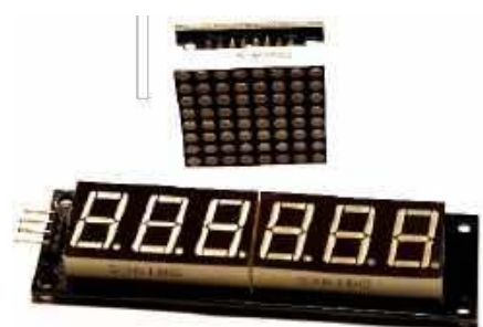
Fotografia 3. Gotowe, chińskie moduły wyświetlacza siedmiosegmentowego i matrycy LED 8x8
