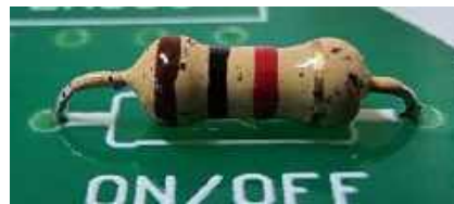
Fotografia 6. Rezystor R1 jest elementem bez polaryzacji i montujemy go na pozycji R1 w dowolnym kierunku. Jego wartość można dla pewności zmierzyć za pomocą multimetru, lub sprawdzić, czy kolejność kolorów kodu paskowego jest zgodna z powyższą fotografią
