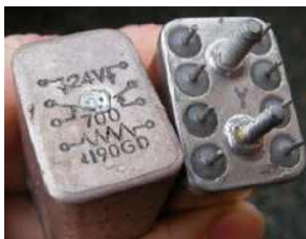
Rysunek 9. Hermetycznie zamknięte przekaźniki 4190 firmy STC do przetaczania sygnałów audio. Mają sprawdzoną żywotność około 30 lat. Takie przekaźniki można rozpoznać po szklanych przepustach wokół styków
