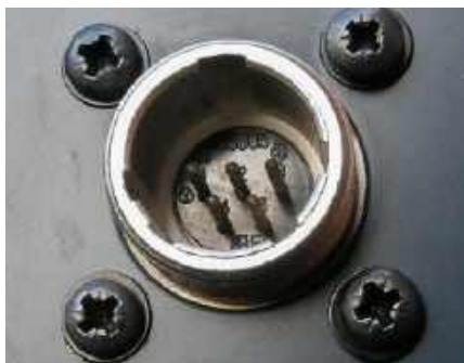
Rysunek 3. Złącza zasilania są zwykle niestandardowe. Znalaziony mikser ma właśnie takie nietypowe złącze. Wtyczka wymagała nieco poszukiwań – eBay jak zwykle zawiódł; na szczęście była w Mouserze
