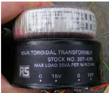
Rysunek 7. Transformatory toroidalne nie grzeją się, emitują mniej pola magnetycznego i mniej brzęczą niż tradycyjne transformatory laminowane. Wyżej pokazano transformator nieobudowany. Ten pokazany niżej (z RS) ma nieco większe rozmiary, ale wytwarza mniejsze zakłócenia
