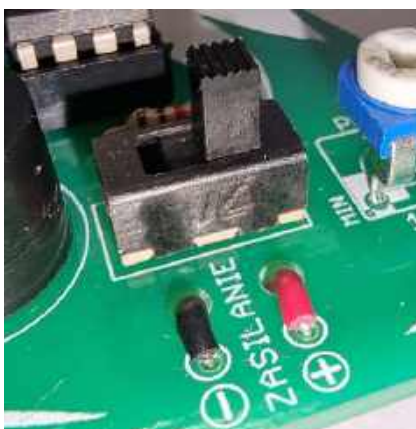
Fotografia 13. Poprawnie zamontowany przełącznik oraz sposób podłączenia kabelków od złącza baterii. Czerwony kabelk należy zamontować do otworu oznaczonego znakiem „+”. Czarny kabelk należy zamontować do otworu oznaczonego znakiem „-”
