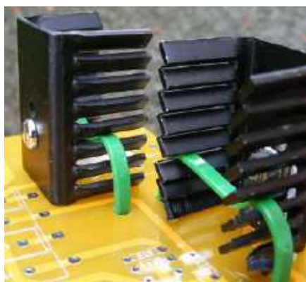
Rysunek 12. W mniej energochłonnych zastosowaniach można użyć radiatorów mniejszych, tłoczonych. Jeśli możesz przez kilka sekund przytrzymać palec na radiatorze, to ma on najwyższej +60°C, a to znaczy, że warunki pracy są prawidłowe
