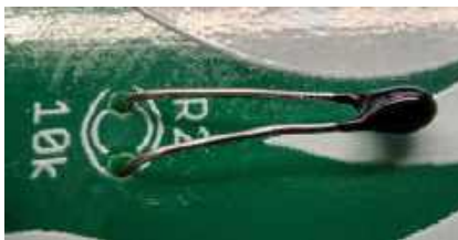
Fotografia 5. Termistor jest szczególnym (wrażliwym na temperaturę) przypadkiem rezystora i tak jak w przypadku rezystora, kierunek jego montażu jest obojętny. Element ten nie posiada zdefiniowanej polaryzacji
