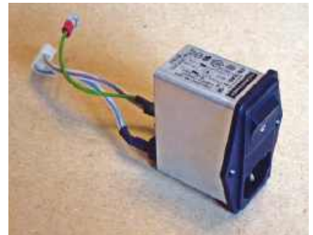
Rysunek 5.9. Złącze sieciowe IEC ze zintegrowanym filtrem EMI
