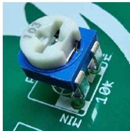
Fotografia 10. Poprawnie zamontowany potencjometr PR1
