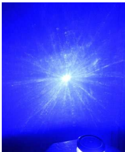
Fot. 5. Inny przykład obrazu otrzymanego w wyniku oświetlenia wiązki niebieskiego światła laserowego piany użytej do wykonania fot. 4 po upływie 20 min.
