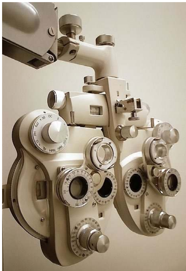
Fot. 2. Głowica foroptera zawiera zestaw soczewek, filtrów i pryzmatów.
