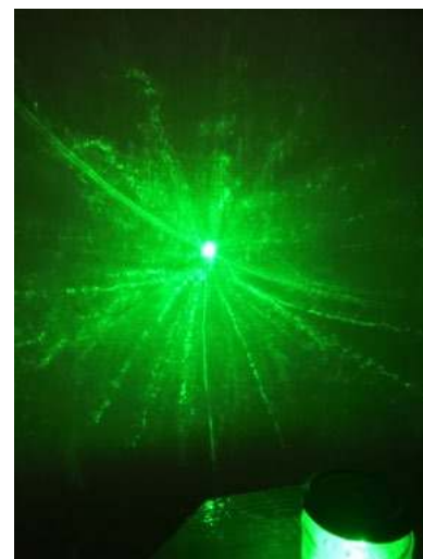
Fot. 6. Przykład obrazu otrzymanego w wyniku oświetlenia piany wiązką zielonego światła laserowego.
