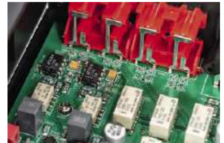
W układzie korekcji gramofonowej zastosowano niskoszumowe, scalone wzmacniacze operacyjne (Analog Devices LT1115).
