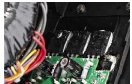
W jednym Mono pracuje w sumie 12 tranzystorów bipolarnych (ON Semi MJL21194).
