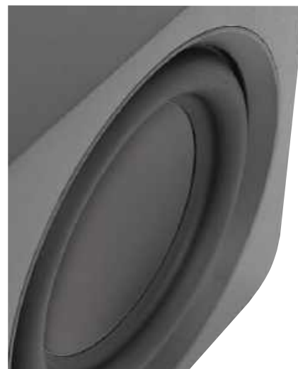
Na jednej ścianie umieszczono 18-cm przetwornik, na drugiej – nieco większą (przepisowo!) 20-cm membranę białą.
