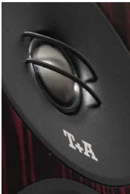
25-mm magnezowa kopułka wysokotonowa pracuje w bardzo szerokim zakresie – od podziału przy 2 kHz aż do 45 kHz.
