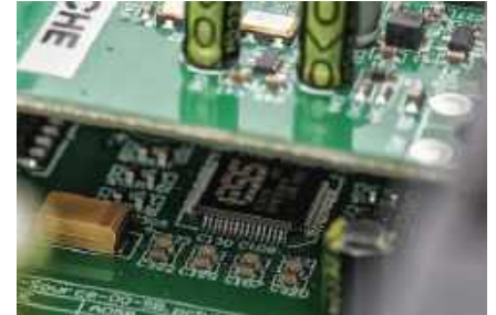
Przetwornik C/A (ES9018) zamontowano nieopodal mechanizmu Play+, w zasadniczej sekcji cyfrowej.
