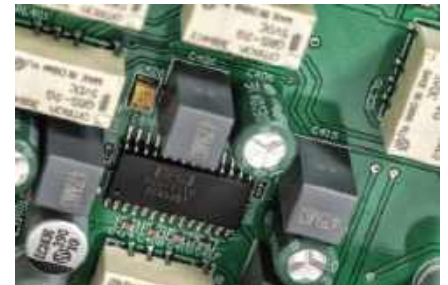
Ze zbalansowanym torem sygnału wiąże się zastosowanie 4-kanalowego, scalonego regulatora głośności (Bunkrowni PGA4311).
