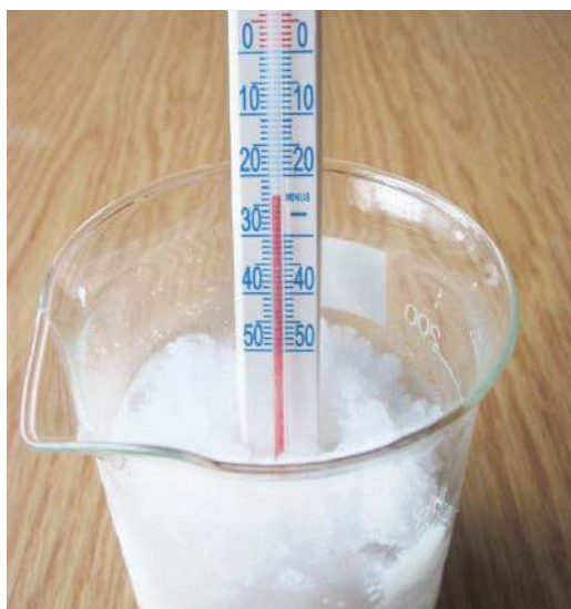
3. Mieszanina lodu z solą pozwala uzyskać temperaturę poniżej -20 stopni
