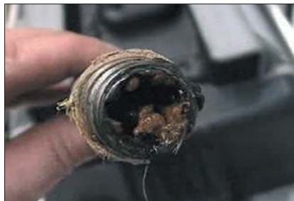
Rys. 4. Skrajny przykład biofilmu na końcu przewodu ze stagnującą wodą Źródło: [23]
