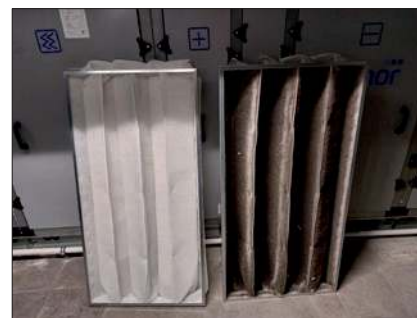
Fot. 4. Porównanie stanu filtra kieszeniowego z centrali wentylacyjnej przed i po eksploatacji Źródło: archiwum autorki
