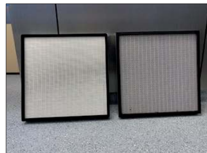
Fot. 5. Porównanie stanu filtra HEPA przed i po eksploatacji Źródło: archiwum autorki
