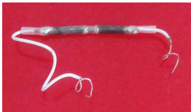
Fot. 6. Wygląd zewnętrzny hybrydowego elementu piezoelektrycznego, wykonanego zgodnie z rys. 3.
