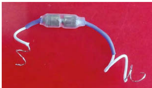
Fot. 5. Wygląd zewnętrzny elementu piezoelektrycznego, połączony z elektrodami w sposób pokazany na rys. 2.
