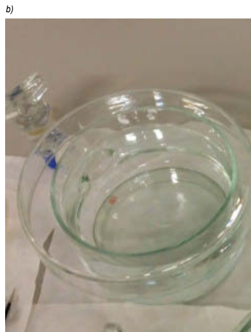
Rys. 5. a) naklejanie ramki z polimeru PDMS na powierzchni grafenu na miedzi, b) ramka z grafenem pływa w naczyniu podczas trawienia miedzi.
