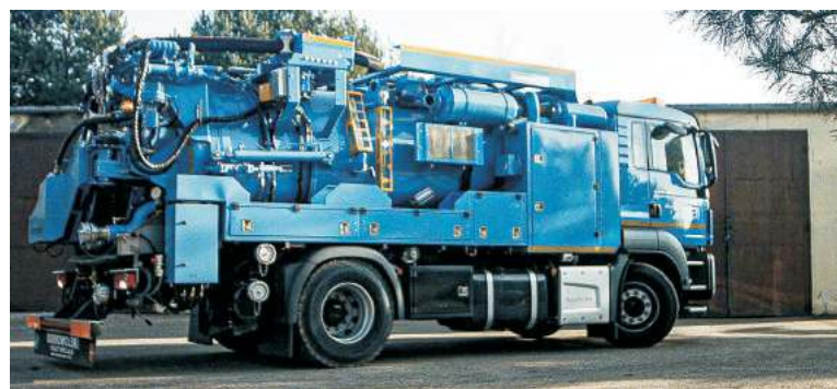
Samochód ciśnieniowo-ssący do obsługi i konserwacji sieci kanalizacji
