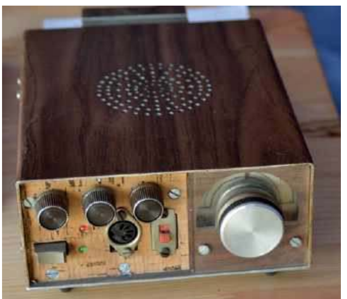
TRX Bartkopodobny (fazowo-homodynowy), wykonany pod koniec ubiegłego wieku przez SP9BWX; obecny właściciel SQ9HHU
