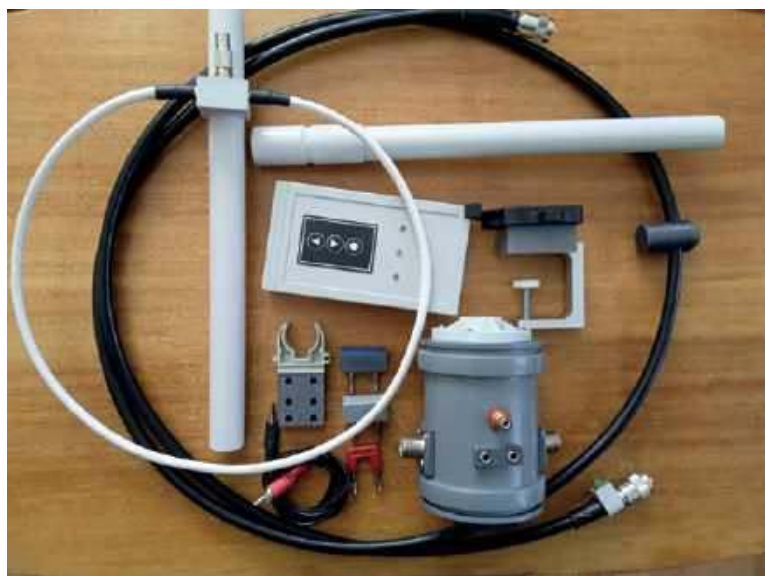
MLA-S (portable RT) w stanie rozłożonym
