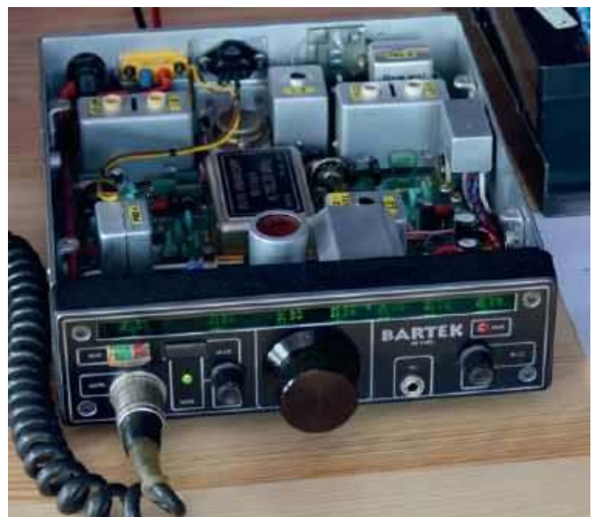
TRX Bartek wykonany w latach 2023–24 przez SP3VZL w wersji oryginalnej z RE 4–5/82 (PCB zakupione na Łosiu 2023, w obudowie Murzynka ze skalą poziomą) w ramach projektu Stowarzyszenia Krótkofalowców Ziemi Jarocińskiej SP3PJA
