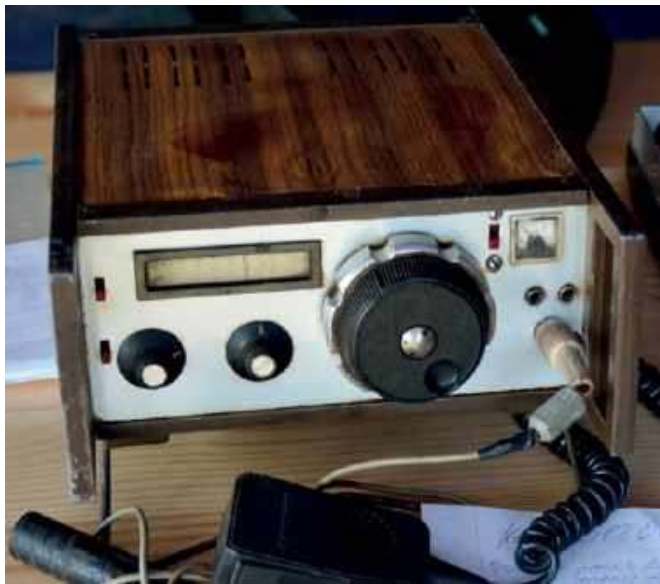
TRX Bartek wykonany w 2001 r. przez SP2ERD do pracy z terenowego QTH (zmodernizowane urządzenie na 3,5 i 7 MHz z mocą 20 W jest wykorzystywane przez Kazika na działce)
