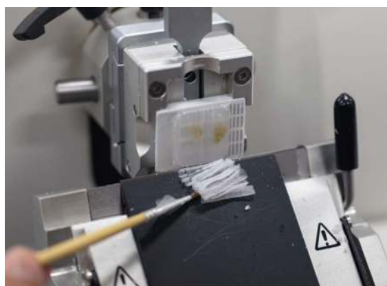
Cięcie materiału na mikrotomie i zbieranie pędzelkiem użytych skrawków
