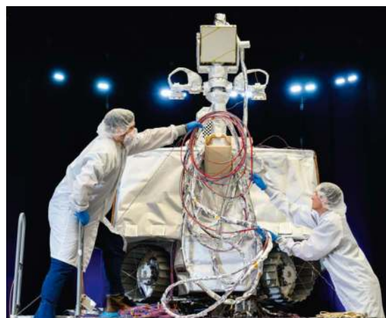
Łazik VIPER, zaprojektowany do badania lotnych związków i poszukiwania śladów lodu wodnego w rejonach polarnych Księżyca
