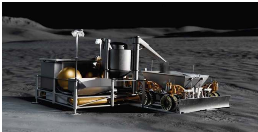
Wizja systemu przetwarzania regolitu pokazuje, że księżycowy pył może być surowcem do budowy przyszłej infrastruktury.
